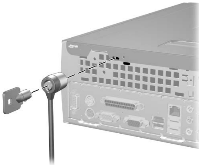
Instalación de un cable de bloqueo
