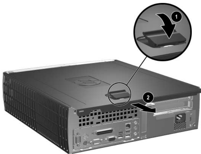
Odstranjevanje pokrova za dostop do notranjosti računalnika
