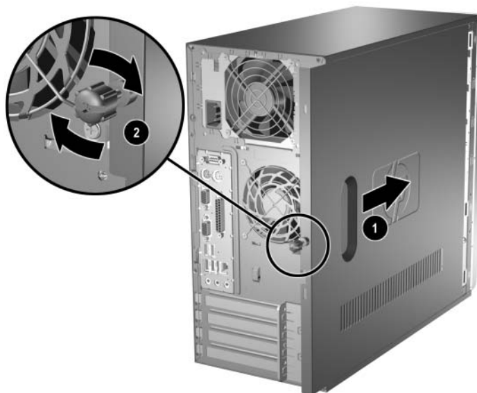
Colocación del panel de acceso lateral
