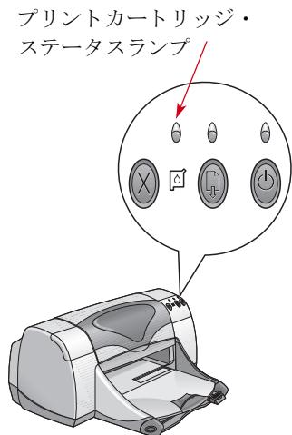
プリントカートリッジの状態をチェックするには、プリンタの上部カバーを開けます。プリントカートリッジ・ホルダの黄色の矢印が5つのプリントカートリッジ・ステータスアイコンのいずれかを指しています。
