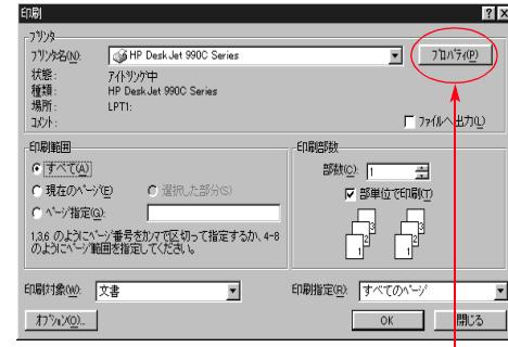
[プロパティ] をクリックして、HP プリンタのプロパティ ダイアログ ボックスを開きます。
