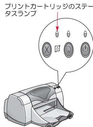
プリントカートリッジのステータスをチェックするには、プリンタの上部カバーを開けてください。プリントカートリッジ・ホルダの黄色い矢印が、5つのプリントカートリッジのステータスアイコンのうちいずれかを指しているはずです。
