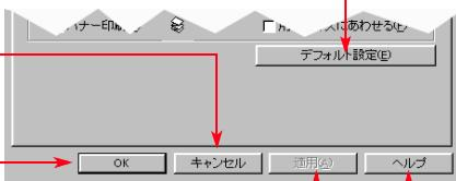
[キャンセル]—変更をキャンセルして、ダイアログボックスを閉じます。
