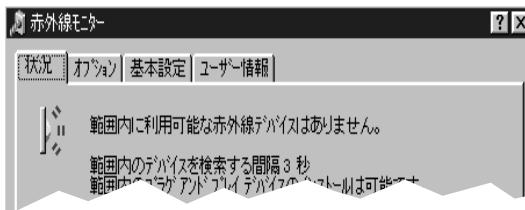
**注意:** コントロールパネルに [赤外線モニタ] アイコンが表示されていない場合は、赤外線ドライバをロードするか、またはコンピュータで赤外線通信の設定を行う必要があります。赤外線ドライバは、Microsoft Windows 98/2000 の CD に収録されているか、Microsoft 社の Web サイト (<http://www.microsoft.com/JAPAN>) からダウンロードできます。
