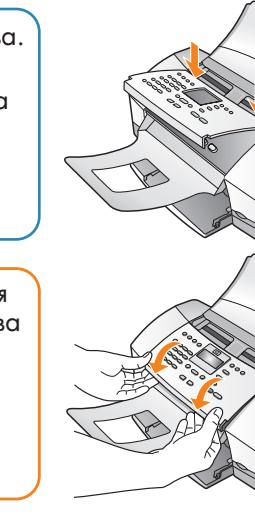
Вставте виступы кришки передньої панелі у заглиблення у верхній частині пристрію. Сильно натисніть на обидва передні кути кришки, щоб вона стала на місце з клацанням. Після цього впевніться, що вона щільно прилягає до пристрію.
