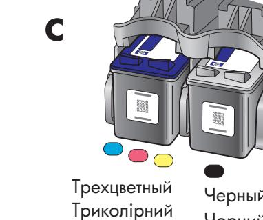
Повторите шаг b для установки трехцветного картриджа в **левой** части каретки.
