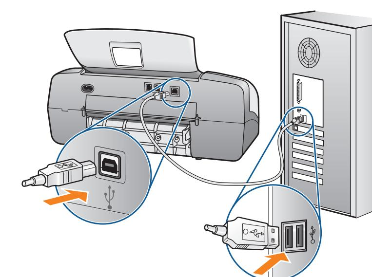
Pastikan, bahwa pada layar komputer Anda terlihat tulisan Set Up Your Device Now (ditunjukkan pada langkah 4), kemudian hubungkan kabel USB. Jangan menghubungkan kabel USB ke keyboard atau ke hub yang tidak ada aliran listrik.
