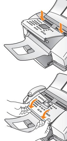
Selipkan tab lapisan atas panel depan ke dalam slot pada bagian atas perangkat. Tekan lapisan ke bawah dengan **mantap** pada kedua sudut depan sampai lapisan menghentak masuk ke dalam tempatnya. Pastikan lapisan
