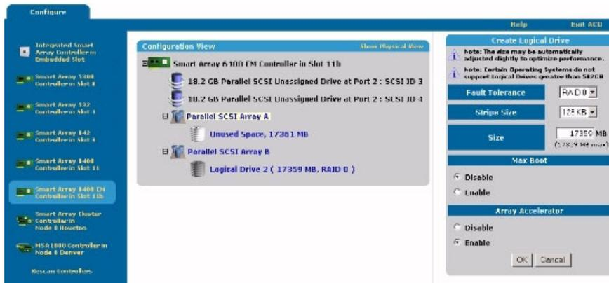
Dies ist der Standardkonfigurationsmodus des ACU. Alle Konfigurationsoptionen für ein im Fenster **Configuration View** (Konfigurationsansicht) ausgewähltes Element werden in einem Rahmen auf der rechten Seite des Bildschirms angezeigt.
