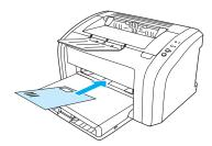
3 Ajuste as guias do meio de impressão de acordo com o comprimento e a largura do envelope.
