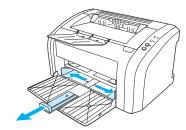
3 Coloque os envelopes com o lado a ser impresso para cima e a margem superior encostada na guia esquerda do meio de impressão. Empilhe até 15 envelopes.
