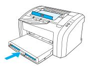
3 Depois de imprimir o lado um, remova os papéis restantes da bandeja de entrada e coloque-os de lado até concluir o trabalho de dúplex manual.
