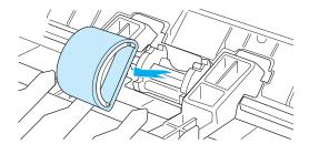
6 Posicione a nova peça ou a peça limpa na abertura do cilindro de recolhimento anterior. Consulte <u>Limpeza do cilindro de recolhimento</u> para obter instruções. As lingüetas circulares e retangulares de cada lado evitam que o cilindro de recolhimento seja colocado de forma incorreta.
