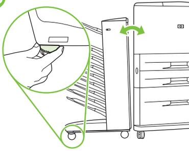
如果打印机和 8 槽邮箱顶部、底部、前部或后部之间的间隙不均匀，请调整 8 槽邮箱脚轮上面的灰色手柄，直至间隙减小。允许存在窄的平行间隙。按照脚轮上面的标签说明进行操作。
