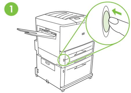
如果您已经将打印机连接至交流电源插座，请按下电源按钮关闭电源（按钮凸出）。
