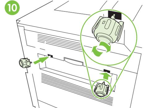
将金属校准托架和磁铁放在打印机护盖孔的前面，插入磁铁并拧紧螺丝，连接托架。
