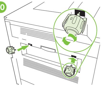
Umieść metalowe wsporniki wyrównujące na wprost otworów po zaslepkach i przymocuj je do drukarki, przykręcając magnesy.
