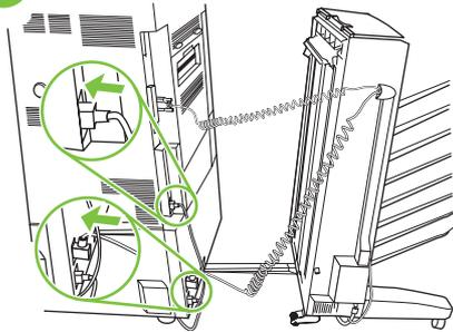
Συνδέστε στον εκτυπωτή το καλώδιο τροφοδοσίας που προορίζεται γι' αυτόν. Συνδέστε στο δίσκο 4 το καλώδιο τροφοδοσίας που προορίζεται γι' αυτόν.
