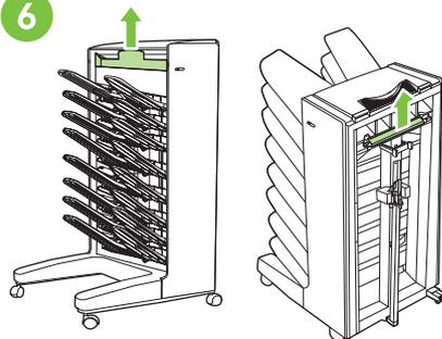
取出 8 槽邮箱两侧顶部附近的包装隔板。
