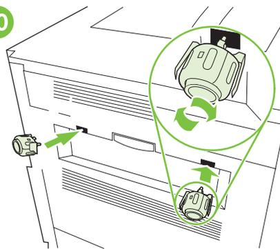
Τοποθετήστε τους μεταλλικούς βραχίονες ευθυγράμμισης και τους μαγνήτες μπροστά στις οπές καλυμμάτων του εκτυπωτή και τοποθετήστε τους βραχίονες εισάγοντας και βιδώνοντας τους μαγνήτες.
