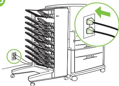
Podłącz przewód zasilający drukarki do gniazdka zasilania. Następnie podłącz przewód zasilający podajnika 4 do gniazdka zasilania.
