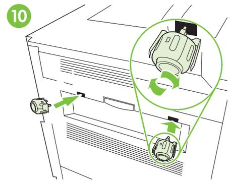
10 Placera justeringsarmarna och magneterna framför skrivarlockhålerna och fäst guiderna genom att trycka i och skruva fast magneterna.
