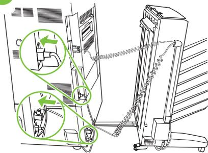
将打印机电源线连接至打印机。将纸盘 4 的电源线连接至纸盘 4。
