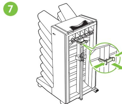
Ściśnij i ściągnij klamerki transportowe umieszczone po wewnętrznej stronie zespołu ośmiu tac odbiorczych.
