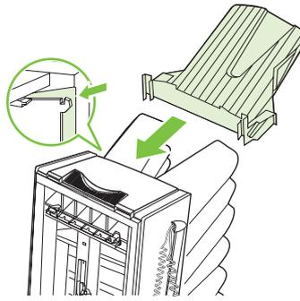
Passa in det vänstra utmatningsfacket som levererades med sorteraren jäms med översidan av sorteraren. Skjut in det vänstra utmatningsfacket så att det snäpper fast.
