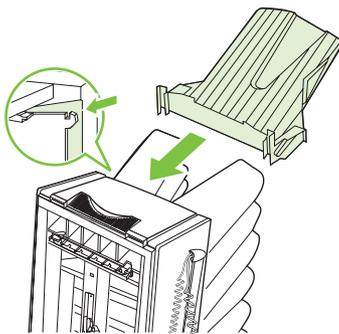
Przyłóż lewą tacę odbiorczą dostarczoną wraz z zespołem ośmiu tac odbiorczych do górnej szczeliny odbiornika. Wepchnij lewą tacę odbiorczą tak, aby zablokowała się we właściwym położeniu.
