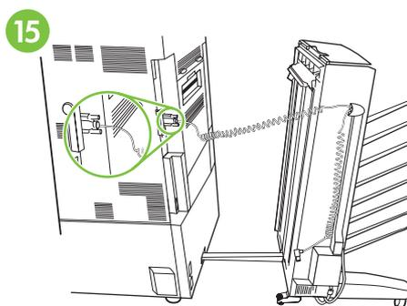
将通信电缆牢固连接至打印机上标有“Accessory”（附件）的接口。
