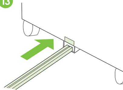
Umieść końcówkę pręta w metalowym gnieździe o przekroju litery U w podajniku 4 i ustal właściwe położenie pręta względem szarego oznaczenia.
