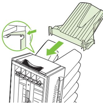
将 8 槽邮箱附带的左出纸槽与 8 槽邮箱的顶部插槽对齐。将左出纸槽推进，直至其锁定到位。
