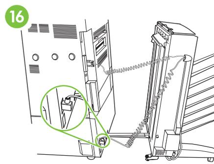
将 8 槽邮箱的电源线连接至纸盘 4 的上部接口。
