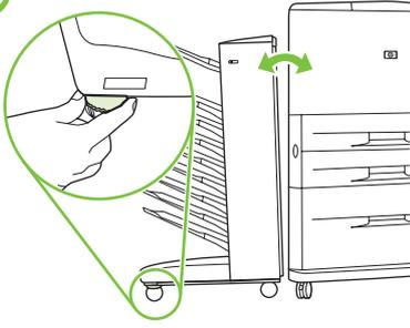
Om mellanrummet mellan skrivaren och sorteraren är ojämnt på någon sida justerar du det med de grå reglagen ovanför sorterarens hjul så att mellanrummet minskas. Ett smalt parallellt mellanrum är godtagbart. Följ etikettanvisningarna ovanför hjulen.
