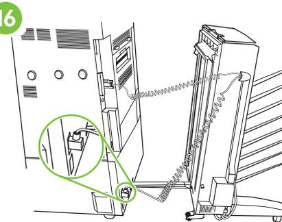
Podłącz przewód zasilający zespołu ośmiu tac odbiorczych do górnego gniazda podajnika 4.
