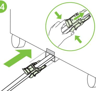
Przesuń niebieski plastikowy wspornik do metalowego gniazda tak, aby zablokować go we właściwym położeniu.
