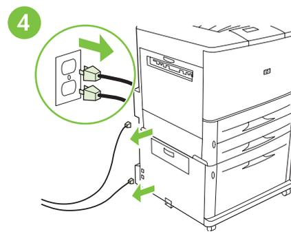
Jeśli przewody zasilające drukarki i podajnika 4 są podłączone, odłącz je od urządzeń oraz wyciągnij wtyczki z gniazdek zasilania.
