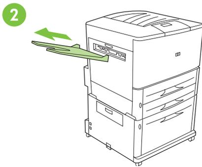
Αφαιρέστε το δίσκο με όψη προς τα πάνω (εάν τον είχατε τοποθετήσει) και φυλάξτε τον. Δεν χρησιμοποιείται όταν η μονάδα ταξινόμησης 8 δίσκων είναι συνδεδεμένη στον εκτυπωτή.
