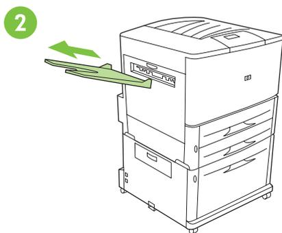
Ta bort utmatningsfacket för utskriftssidan uppåt (om det är installerat) och lägg det åt sidan. Det används inte när du anslutit sorteraren med 8 fack till skrivaren.
