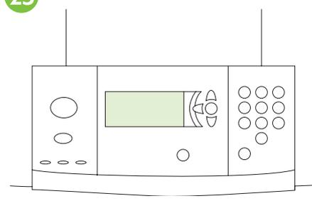
Περιμένετε για να εμφανιστεί η ένδειξη READY (Έτοιμος) στον πίνακα ελέγχου του εκτυπωτή. **Σημείωση:** Ο δικός σας πίνακας ελέγχου ίσως να μην είναι ακριβώς ίδιος με τον εικονιζόμενο.
