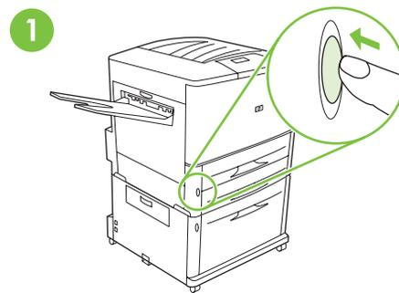
Jeśli urządzenie jest podłączone do gniazdka zasilania, naciśnij przycisk zasilania, aby je wyłączyć (przycisk niewciśnięty).
