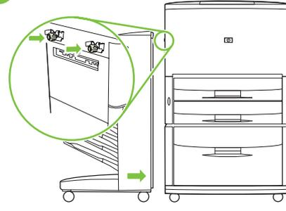
将 8 槽邮箱推向打印机，8 槽邮箱应滑进打印机并触及打印机上的两块磁铁，然后将 8 槽邮箱锁定到位。
