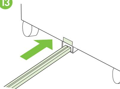
Sätt in änden på anslutningsstängan i den U-formade metallskåran på fack 4 och rikta in stängan mot den grå justeringsetiketten.
