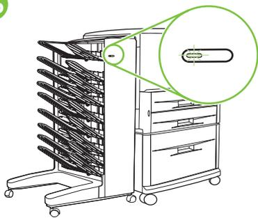
Βεβαιωθείτε ότι η φωτεινή ένδειξη στο μπροστινό μέρος της μονάδας ταξινόμησης 8 δίσκων είναι σταθερή πράσινη. Εάν η φωτεινή ένδειξη είναι κίτρινη, αναβοσβήνει ή είναι σβηστή, δείτε τον ηλεκτρονικό οδηγό με τίτλο «Χρήση» στη διεύθυνση [www.hp.com](http://www.hp.com).
