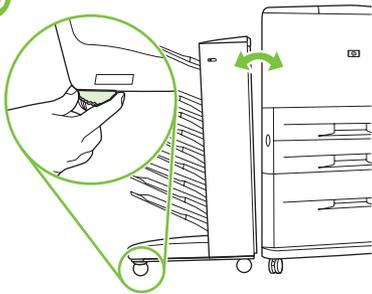
Jeśli pomiędzy drukarką a zespołem ośmiu tac odbiorczych jest widoczna nierówna szczelina, należy ją zmniejszyć za pomocą szarych regulujących pokręteł umieszczonych nad kółkami odbiornika. Dopuszczalna jest wąska równoległa szczelina. Szczegółowe instrukcje umieszczono na oznaczeniu nad kółkami.
