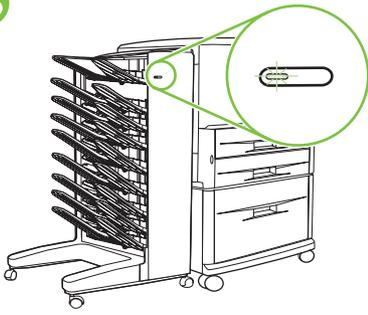
Kontrollera att lampan på sorterarens framsida lyser grönt med fast sken. Om lampan lyser gult, blinkar eller är släckt, se onlinehandboken *Användning* på webbplatsen [www.hp.com](http://www.hp.com).
