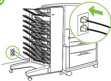
将打印机电源线重新连接至交流电源插座。将纸盘 4 的电源线重新连接至交流电源插座。
