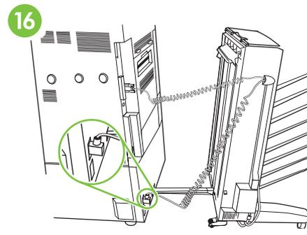
Συνδέστε το καλώδιο τροφοδοσίας στη μονάδα ταξινόμησης 8 δίσκων με την πάνω σύνδεση του δίσκου 4.
