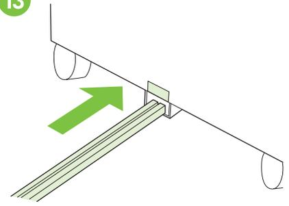
Τοποθετήστε το άκρο της ράβδου σύνδεσης στη μεταλλική υποδοχή σχήματος U στο δίσκο 4 και ευθυγραμμίστε τη ράβδο με την γκρι ετικέτα ευθυγράμμισης.
