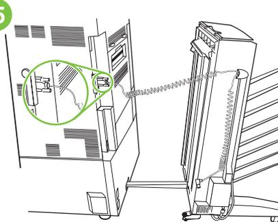
Podłącz kabel łączności do złącza drukarki oznaczonego jako „Accessory” (Wyposażenie).
