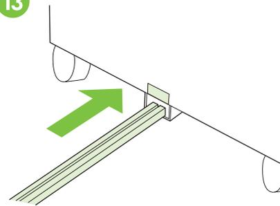
将连接杆的一端插入纸盘 4 的 U 形金属槽中，并将杆与灰色校准标签对齐。
