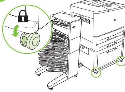
将打印机放置在安装位置，然后锁定前脚轮。
