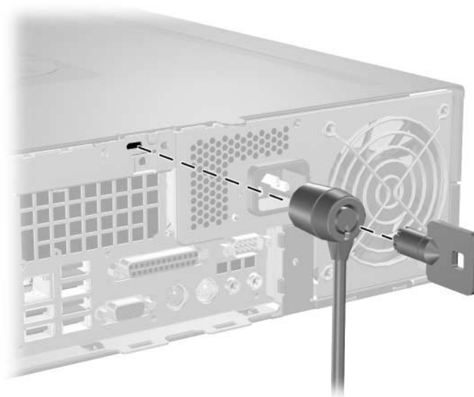
Installation d'un câble de sécurité
