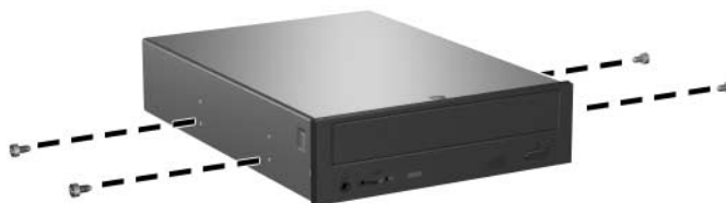
Instalación de tornillos de guía en la unidad óptica
