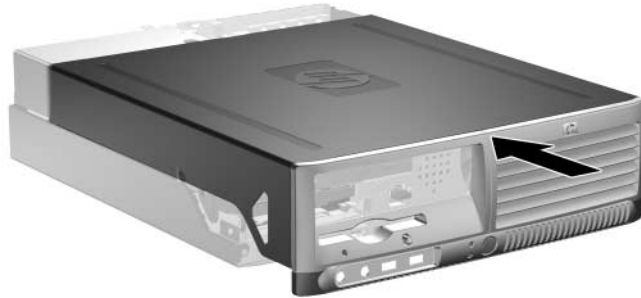
Colocación de la cubierta del equipo
