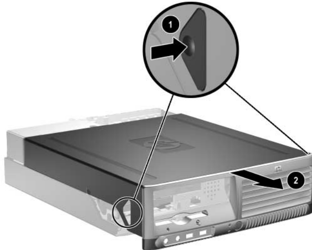
Extracción de la cubierta del equipo
