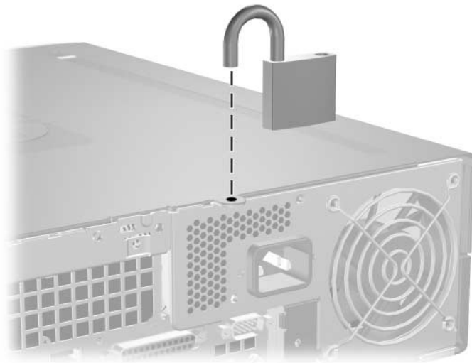
Instalación de un candado
