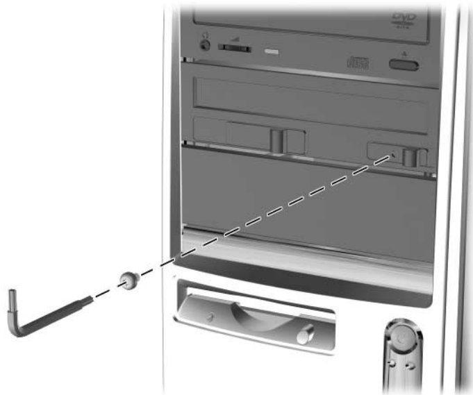
Desinstalación del tornillo de seguridad del compartimiento multiuso (se muestra una llave de tipo llave de tuercas)
