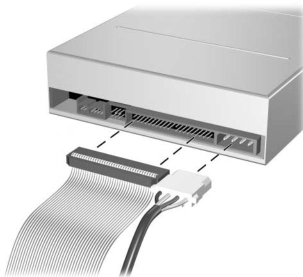
Conexión de los cables de la unidad
