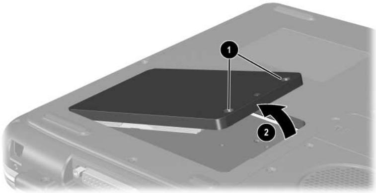
*Rimozione delle viti di fissaggio del gruppo unità disco rigido*
