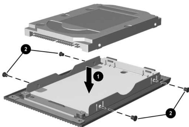
*Inserimento dell'unità disco rigido nel relativo alloggiamento*
