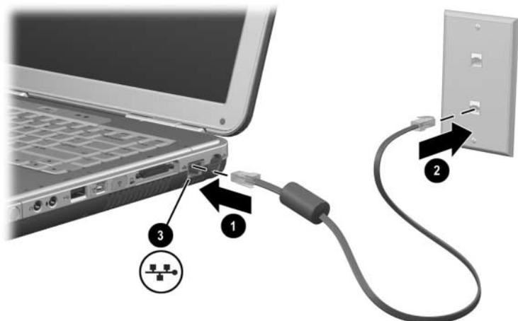
Collegamento di un cavo di rete RJ-45
