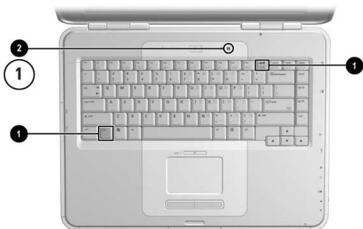
Identificazione dei tasti **Fn** e **bloc num** e della spia del blocco numerico
