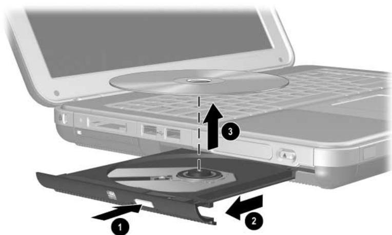
*Rimozione di un CD o DVD da un'unità ottica quando il sistema è alimentato*
