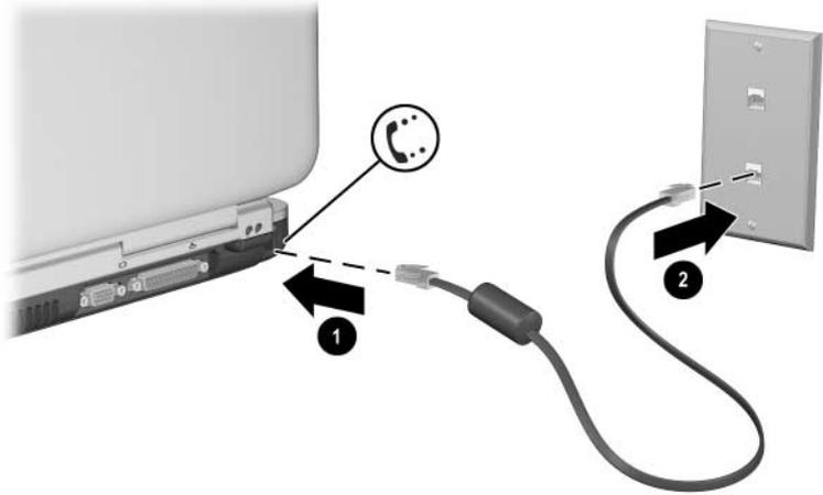
Connessione del cavo modem RJ-11
