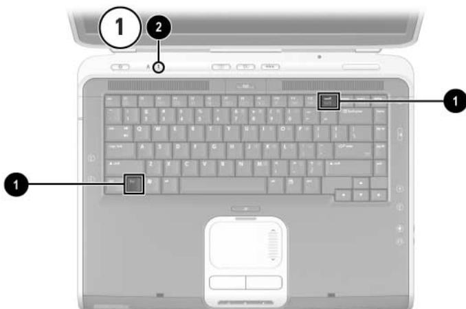
Identificazione dei tasti **Fn** e **bloc num** e della spia del blocco numerico
