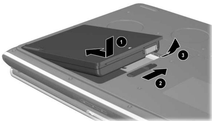
*Inserimento o rimozione della batteria*
