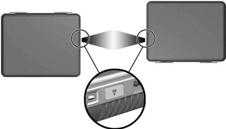
*Connessione con un altro sistema a infrarossi*
