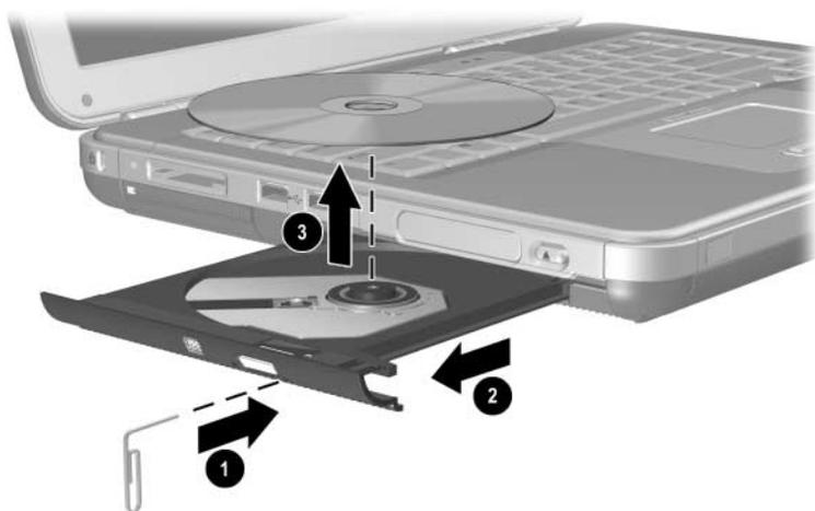
*Rimozione di un CD o DVD da un'unità ottica quando il sistema non è alimentato*
