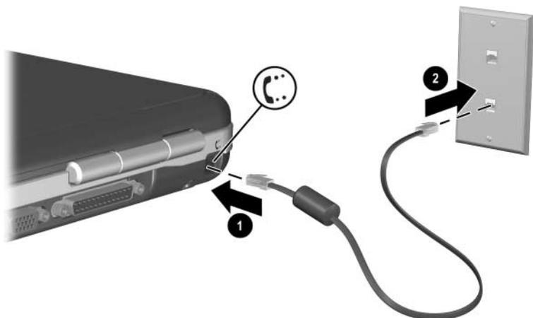
Connessione del cavo del modem RJ-11
