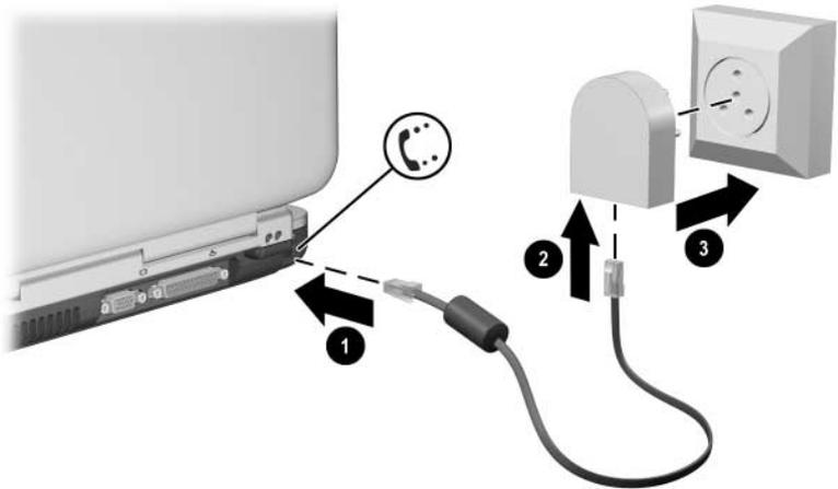
Connessione di un cavo del modem tramite un adattatore per modem
