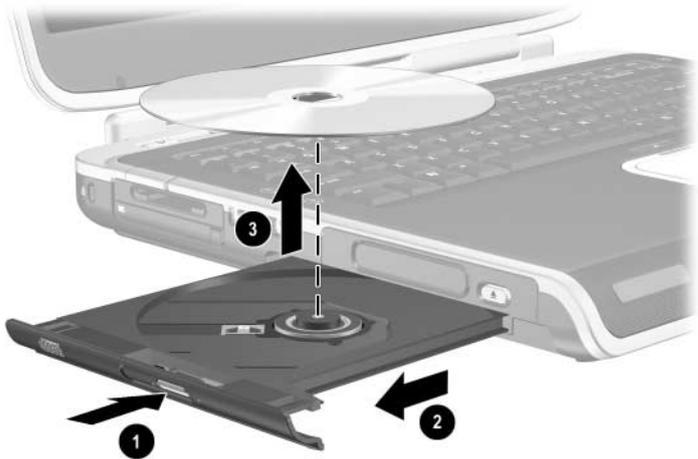
*Rimozione di un CD o DVD da un'unità ottica quando il sistema è alimentato*
