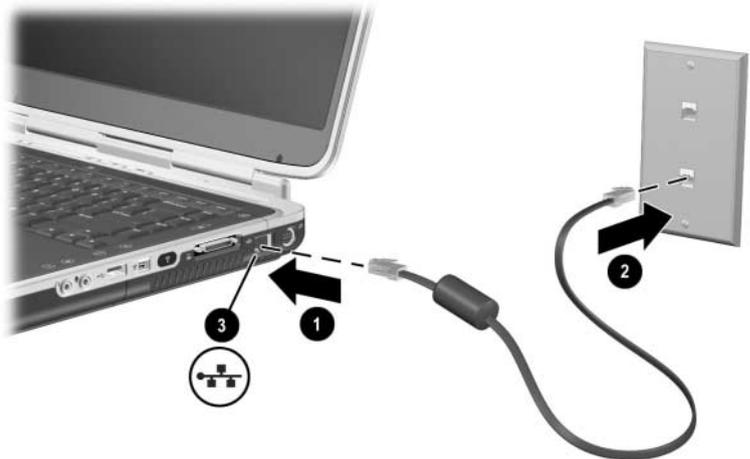
Collegamento di un cavo di rete RJ-45
