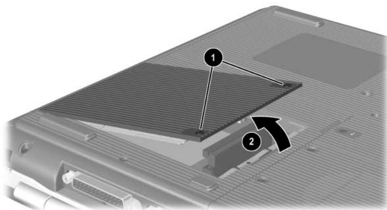
*Rimozione delle viti di fissaggio del gruppo unità disco rigido*
