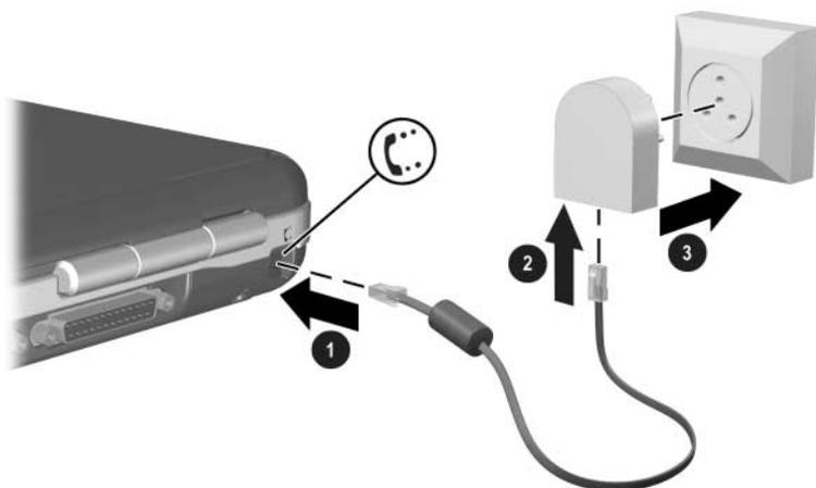
*Connessione di un cavo del modem tramite un adattatore per modem*
