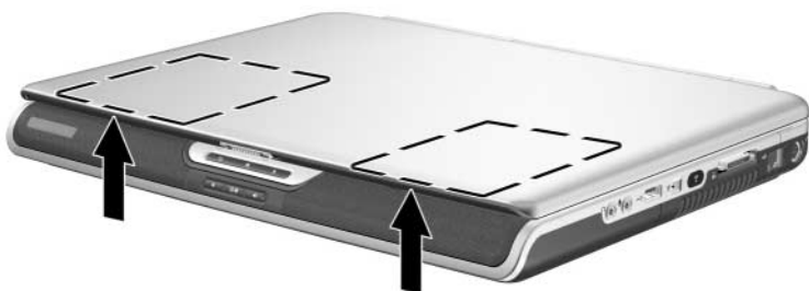
Plassering av trådløse antenner
