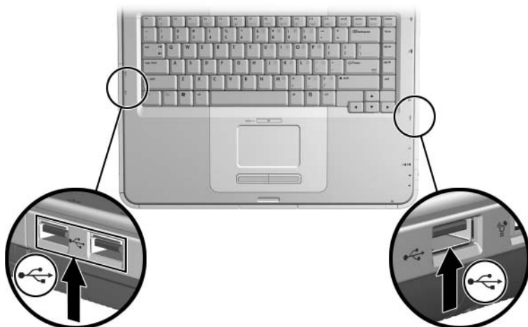
A bal oldali két, illetve a jobb oldali egy USB-csatlakozó helye
