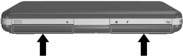
A beépített hangszórók
