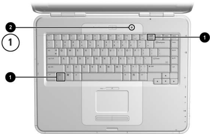
Az Fn és Num Lock billentyűk, illetve a Num Lock LED elhelyezkedése
