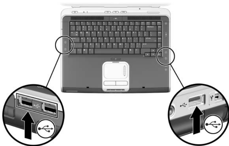
A bal oldali két, illetve a jobb oldali egy USB-csatlakozó helye
