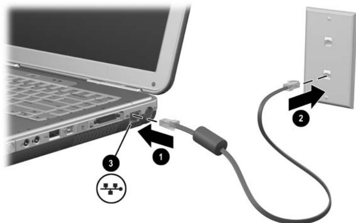
RJ-45-ös hálózati kábel csatlakoztatása
