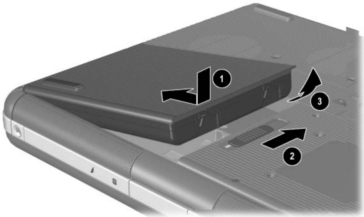
Az akkumulátor behelyezése és eltávolítása
