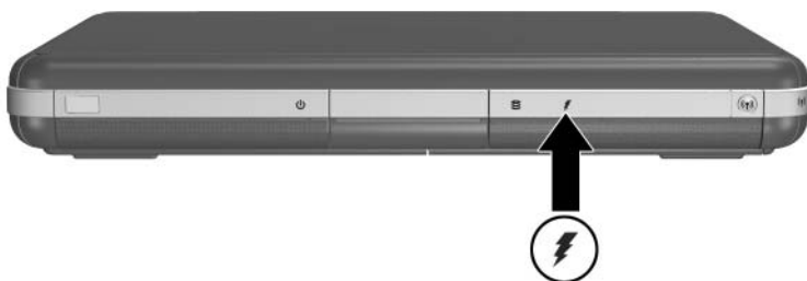
A töltésjelző LED elhelyezkedése
