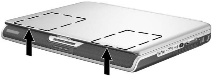
A vezeték nélküli kapcsolat antennájának helye
