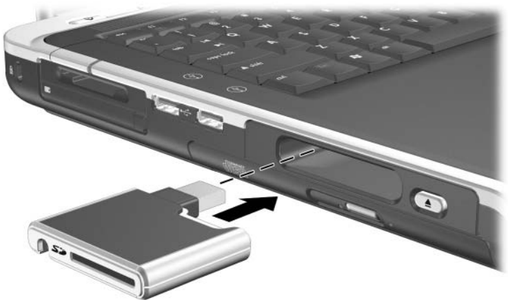
Wkładanie napędu cyfrowego do wnęki cyfrowej
