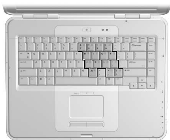
Rozmieszczenie klawiszy bloku klawiszy numerycznych
