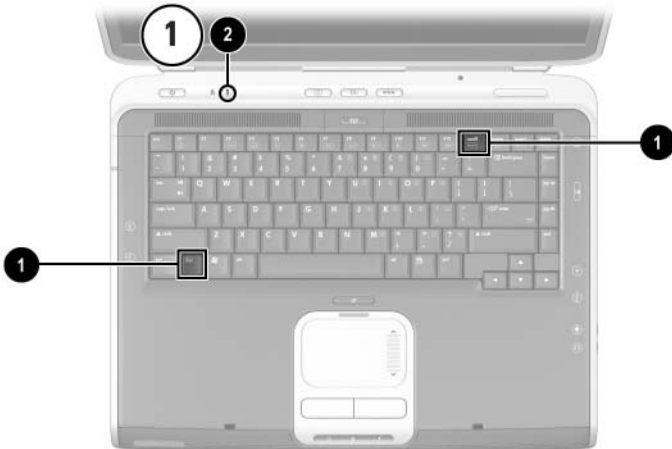
Położenie klawiszy Fn i num lock oraz wskaźnika num lock
