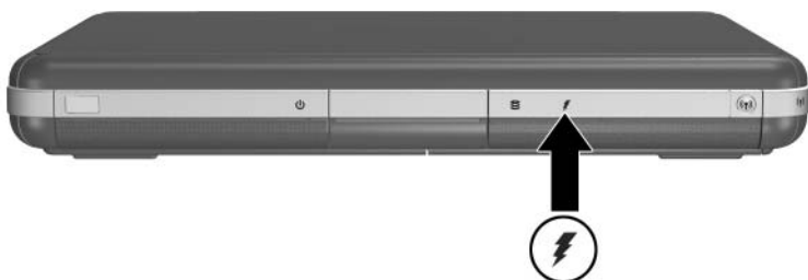
Umieszczenie wskaźnika baterii
