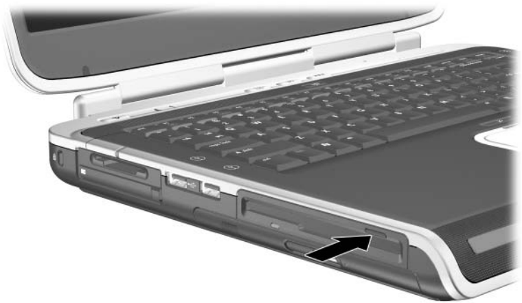
Przycisk zwalniający nośnik z napędu dyskietek
