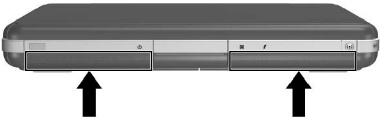
Położenie głośników wewnętrznych
