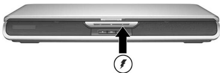
Umieszczenie wskaźnika baterii
