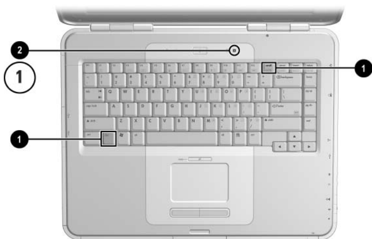
Położenie klawiszy Fn i num lock oraz wskaźnika num lock
