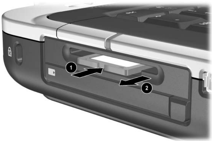
Wymywanie cyfrowej karty multimedialnej
