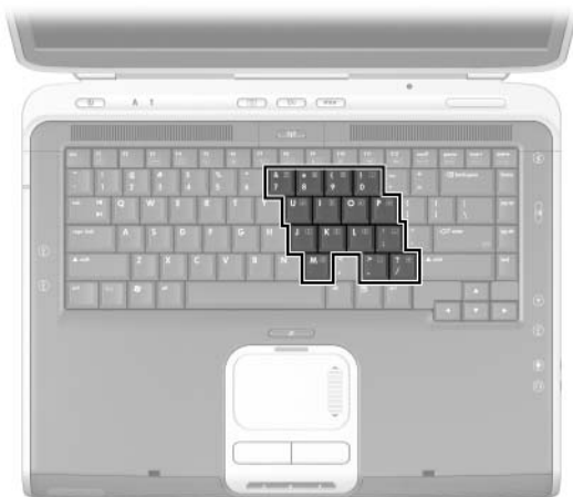
Roźmieszczenie klawiszy bloku klawiszy numerycznych
