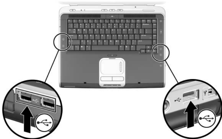
Dwa złącza USB z lewej strony i jedno złącze USB z prawej strony komputera
