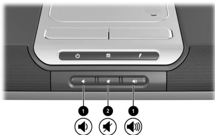
Położenie przycisków regulacji głośności
