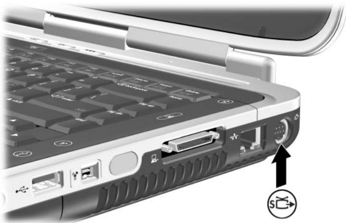
Położenie wyjściowego gniazda S-Video
