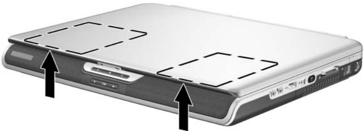
Położenie anteny urządzenia bezprzewodowego
