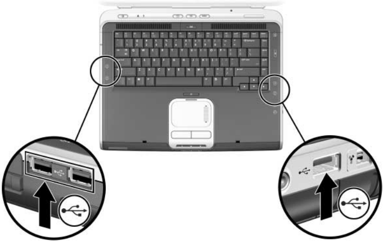
Twee USB-connectoren aan de linkerkant en één USB-connector aan de rechterkant
