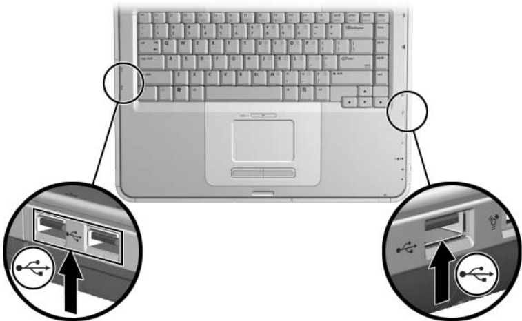
Twee USB-connectoren aan de linkerkant en één USB-connector aan de rechterkant
