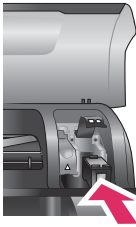
Einsetzen einer Druckpatrone
