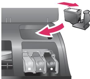
Wenn Sie eine Druckpatrone aus dem Drucker entfernen, bewahren Sie diese in der speziellen Schutzvorrichtung (falls vorhanden) auf. Diese Schutzvorrichtung verhindert das Austrocknen der Tinte. Bei falscher Lagerung der Druckpatrone kann dieser Fehler hervorrufen.
