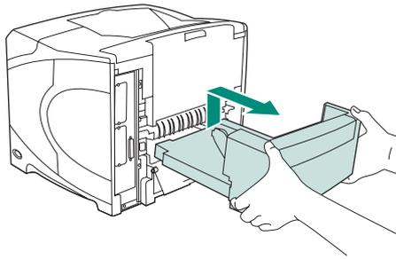
**De duplexeenheid verwijderen:** Draai de printer zo, dat de achterklep naar u toe is gericht. Til de duplexeenheid op en trek deze uit de printer.
