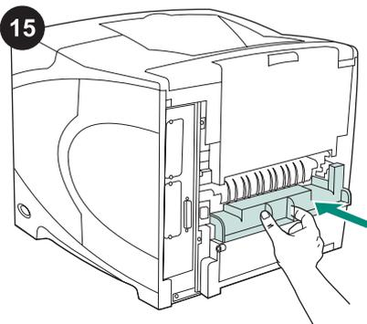
Installare il coperchio dell'alloggiamento dell'unità duplex se si desidera utilizzare la stampante senza l'unità duplex.
