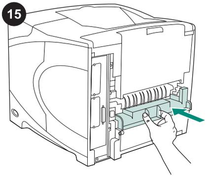
Plaats het deksel weer op de sleuf als u de printer zonder de duplexeenheid wilt gebruiken.
