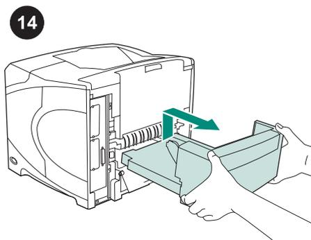
**So entfernen Sie den Duplexer:** Drehen Sie den Drucker so, dass die hintere Abdeckung zu Ihnen weist. Heben Sie den Duplexer an, und ziehen Sie ihn heraus.
