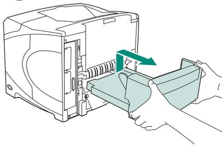
**Para remover o duplexador:** Vire a impressora de forma que a tampa traseira fique voltada para você. Levante e puxe-a para fora para remover o duplexador.
