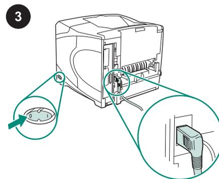
Zet de printer uit. Gebruik de netstekker met haakse connector die bij de printer wordt geleverd.
