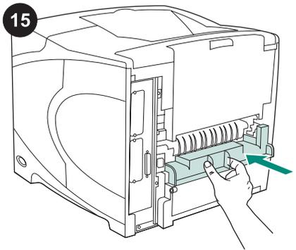
Instale a tampa do slot do duplexador caso a impressora seja utilizada sem ele.
