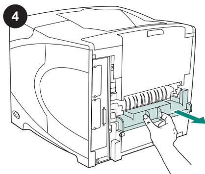
4 Remova a tampa do slot do duplexador da parte de trás da impressora.
