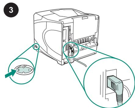
3 Desligue a impressora. Verifique se você está usando o plug de alimentação em ângulo reto que veio com a impressora.
