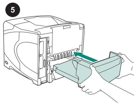
5 Usando as duas mãos, insira o duplexador completamente no slot.
