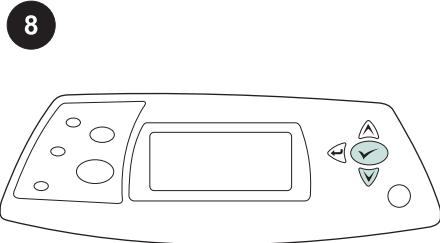
要检验安装是否完成，请从控制面板打印配置页。按下  $\checkmark$  键打开打印机菜单。按下  $\downarrow$  键选择 INFORMATION（信息），然后按下  $\checkmark$  键。按下  $\downarrow$  键选择 PRINT CONFIGURATION（打印配置），然后按下  $\checkmark$  键。
