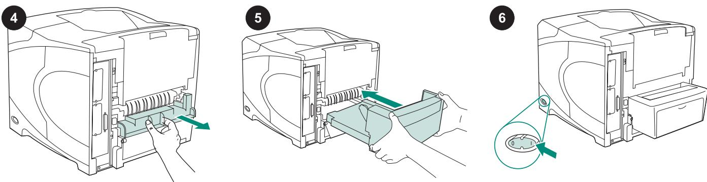
Odstraňte kryt slotu určeného pro jednotku pro oboustranný tisk ze zadní strany tiskárny.
