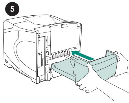
Χρησιμοποιώντας και τα δύο χέρια, εισαγάγετε πλήρως το εξάρτημα εκτύπωσης δύο όψεων στην υποδοχή.
