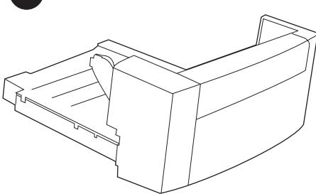
Η συσκευασία αυτή περιέχει ένα εξάρτημα εκτύπωσης δύο όψεων, το οποίο χρησιμοποιείται για την αυτόματη εκτύπωση δύο όψεων.
