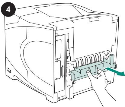
Αφαιρέστε το κάλυμμα της υποδοχής του εξαρτήματος εκτύπωσης δύο όψεων από το πίσω μέρος του εκτυπωτή.
