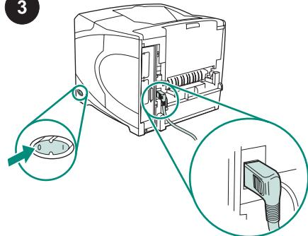
プリンタの電源を切ります。プリンタ付属の直角の電源プラグを使用していることを確認してください。
