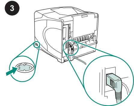
Κλείστε τον εκτυπωτή. Βεβαιωθείτε ότι χρησιμοποιείτε το βύσμα τροφοδοσίας σε σχήμα ορθής γωνίας που συνοδεύει τον εκτυπωτή.
