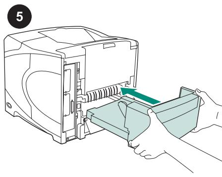
用双手将双面打印器插入插槽。
