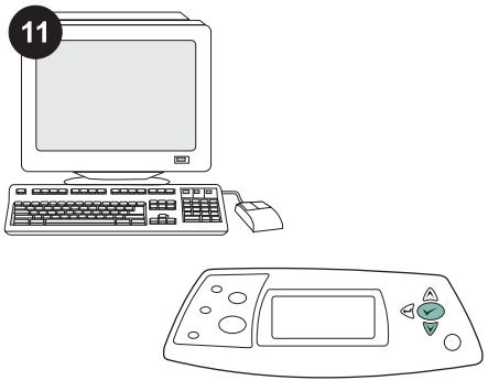
Pilih duplex atau pencetakan dua-sisi dari program Anda. Jika kedua opsi ini tidak tersedia dalam program, gunakan menu panel kontrol printer untuk menghidupkan duplexing. Untuk informasi lebih lanjut, lihat panduan penggunaan pada CD-ROM yang disertakan dengan printer.
