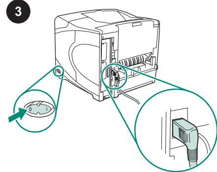
Matikan printer. Pastikan Anda menggunakan colokan listrik sudut-kanan yang disertakan dengan printer.
