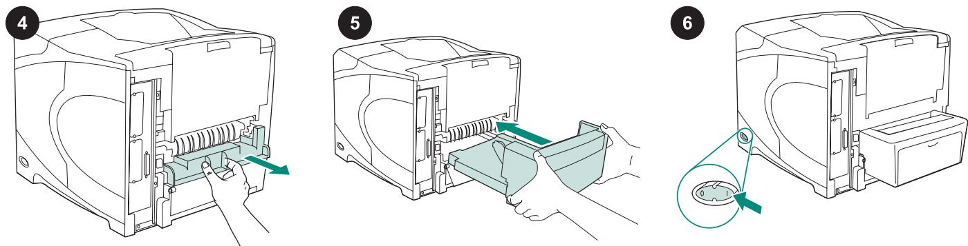
Снимите крышку с гнезда для устройства двусторонней печати, расположенного сзади принтера.
