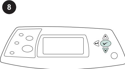
หากคุณต้องการตรวจสอบว่าการติดตั้งทำได้โดยสมบูรณ์หรือไม่ ให้ลั่งพิมพ์หน้าแสดงค่าค่อนฟิกและการตั้งค่าอุปกรณ์สำหรับพิมพ์ ให้กด ▾ เพื่อเปิดคูณูต่างๆ ของเครื่องพิมพ์กด ▾ เพื่อเลือก ข้อมูล และกด ▾ กด ▾ เพื่อเลือก การตั้งค่าค่อนฟิกการพิมพ์แล้วกด ▾
