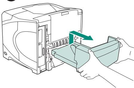
**Удаление устройства двусторонней печати** Поверните принтер задней панелью к себе. Поднимите и вытащите устройство двусторонней печати.
