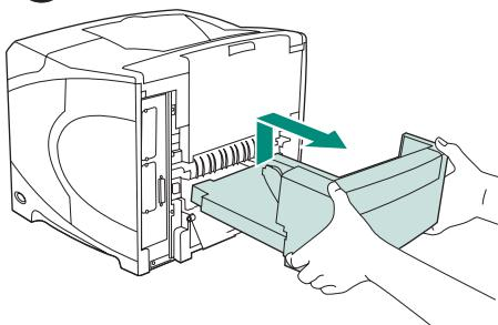
**両面印刷ユニットを取り外すには：** 後部カバーが手前を向くように、プリンタを回転させます。両面印刷ユニットを持ち上げて引き出します。
