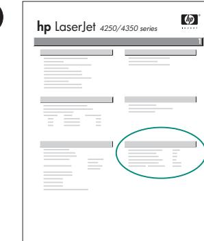
确保配置页上列出双面打印机是已安装附件。如果未列出双面打印机，请参阅打印机随附的 CD-ROM 上的使用指南。
