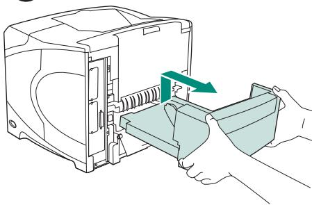
**卸下双面打印器：** 旋转打印机，以使其后盖朝向您。向上提起双面打印器，然后拉出即可将其卸下。
