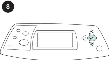
Správnost instalace zkontrolujte vytisknutím konfigurační stránky z ovládacího panelu. Stisknutím tlačítka otevřete nabídky tiskárny. Stisknutím tlačítka vyberete možnost **INFORMACE**. Poté stiskněte tlačítko . Následným stisknutím tlačítka vyberte možnost **KONFIGURACE TISKU**. Poté stiskněte tlačítko .
