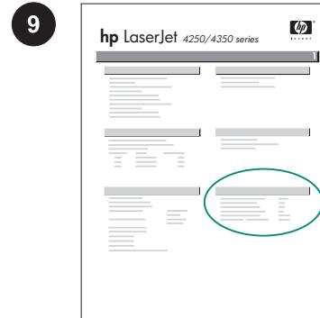
Ellenőrizze, hogy a konfigurációs lapon szerepel-e a kétoldalas egység, mint telepített tartozék. Ha a kétoldalas egység nincs feltüntetve, tekintse át a nyomtatóhoz kapott CD-lemezen található felhasználói útmutatót.
