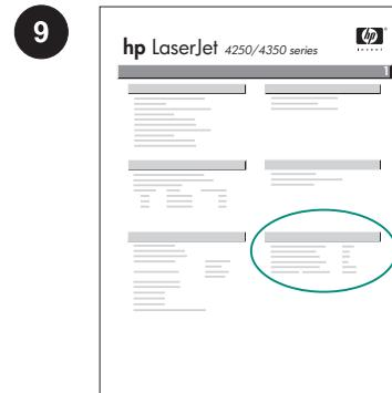
Убедитесь, что на странице конфигурации устройство двусторонней печати указано в качестве установленного компонента. Если устройство двусторонней печати не указано на странице конфигурации, см. руководство пользователя на компакт-диске, поставляемом с принтером.
