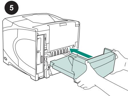
両面印刷ユニットを両手で完全にスロットに挿入します。
