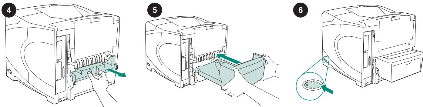
Távolítsa el a nyomtató hátsó részéről a kétoldalas egység helyét eltakaró fedelel.
