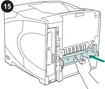
Если принтер будет использоваться без устройства двусторонней печати, установите крышку на гнездо устройства.
