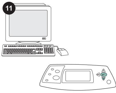
Выберите в приложении устройство двусторонней печати или параметр двусторонней печати. Если ни один из этих параметров в приложении не доступен, для включения двусторонней печати используйте меню панели управления принтера. Для получения дополнительных сведений см. руководство пользователя на компакт-диске, поставляемом вместе с принтером.
