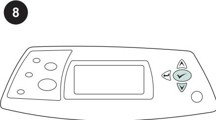
Για να βεβαιωθείτε ότι η εγκατάσταση ολοκληρώθηκε, εκτυπώστε μια σελίδα διαμόρφωσης από τον πίνακα ελέγχου. Πατήστε **✓**, για να ανοίξουν τα μενού του εκτυπωτή. Πατήστε **▼**, για να επιλέξετε **INFORMATION** (Πληροφ.) και μετά **✓**. Πατήστε **▼**, για να επιλέξετε **PRINT CONFIGURATION** (Εκτύπ. ρυθμ.) και μετά **✓**.
