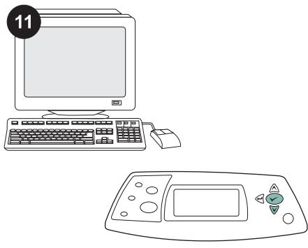
Állítsa be a duplex vagy kétoldalas nyomtatási beállítást a programban. Ha a programban ezen lehetőségek egyike sem választható, a nyomtató vezérlőpanel-menüjének használatával kapcsolja be a kétoldalas nyomtatást. További információért tekintse át a nyomtatóhoz kapott CD-lemezen található felhasználói útmutatót.
