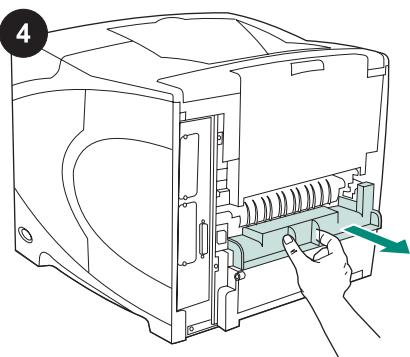
プリンタの背面から両面印刷スロット カバーを取り外します。
