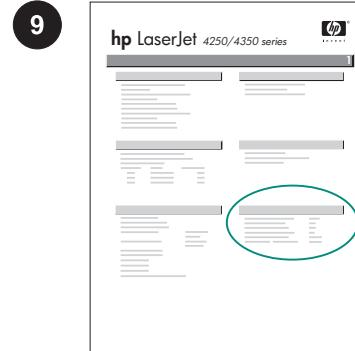
Βεβαιωθείτε ότι στη σελίδα διαμόρφωσης υπάρχει το εξάρτημα εκτύπωσης δύο όψεων ως εγκατεστημένο εξάρτημα. Εάν το εξάρτημα εκτύπωσης δύο όψεων δεν αναφέρεται, δείτε τον οδηγό χρήση στο CD-ROM που συνοδεύει τον εκτυπωτή.
