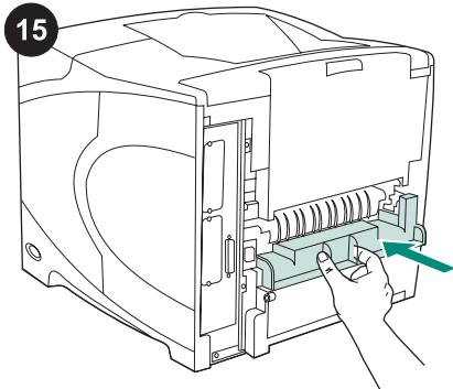
Ha a nyomtatót a kétoldalas egység nélkül szeretné használni, akkor helyezze vissza a nyomtató hátsó részére a kétoldalas egység helyét eltakaró fedelet.
