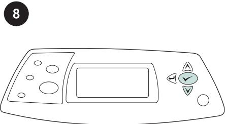
Kurulum işleminin tamamlandıktan emin olmak için kontrol panelinden bir yapılandırma sayfası yazdırın. Yazıcı menülerini açmak için **✓** tuşuna basın. **BİLGİ** menüsünü seçmek için **▼** tuşuna basın ve daha sonra **✓** tuşuna basın. **YAPILANDIRMA YAZDIR** menüsünü seçmek için **▼** tuşuna basın ve daha sonra **✓** tuşuna basın.
