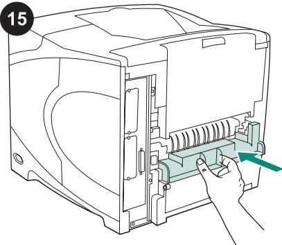
両面印刷ユニットなしでプリンタを使用する場合は、両面印刷スロット カバーを取り付けます。
