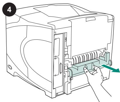
从打印机后部取下双面打印插槽的盖板。
