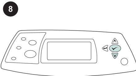
Для проверки правильности установки следует распечатать страницу конфигурации с панели управления. Для входа в меню нажмите кнопку **✓**. Нажмите кнопку **▼** для выбора пункта **ИНФОРМАЦИЯ**, а затем нажмите кнопку **✓**. Нажмите кнопку **▼** для выбора пункта **ПЕЧАТЬ КОНФИГУРАЦИИ**, а затем нажмите кнопку **✓**.
