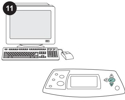
เลือกอุปกรณ์สำหรับพิมพ์งานสองด้าน หรือการพิมพ์สองด้าน จากโปรแกรมของคุณ หากไม่สามารถใช้ตัวเลือกเหล่านี้ในโปรแกรม ให้ใช้เมนูบนแผงควบคุมของเครื่องพิมพ์เพื่อเปิดการพิมพ์งานสองด้าน สำหรับรายละเอียดเพิ่มเติม ให้ดูค่าแนะนำบนแผ่นซึ่งมีรายละเอียดเพิ่มเติม ให้ดูที่คู่มือการใช้งานซึ่งมีรายละเอียดเพิ่มเติมที่มาพร้อมกับเครื่องพิมพ์
