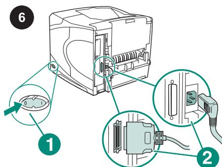
6 Sluk printeren (billede 1). Tag alle kabler ud bag på printeren (billede 2). **Bemærk!** Der kan være tilsluttet ekstra kabler, som ikke vises på denne illustration. Kontroller, at du tager *alle* kabler ud bag på printeren.
