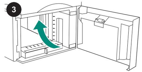
3 Poista oranssit teipit ja muut pakkausmateriaalit. Huomautus: Varmista, että poistat kaiken pakkausmateriaalin ja oranssin teipin 1 500 arkin syöttölaiteesta.
