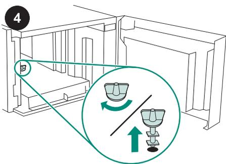
4 **FORSIGTIG!** Låsen på bakken til arkføderen til 1.500 ark *skal* fjernes, før du bruger arkføderen. Drej låsen på arkføderens bakke med uret, og træk den derefter opad og ud af arkføderen.
