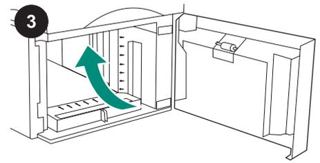
Verwijder alle oranje tape en verpakkingsmaterialen. N.B.: controleer ook of er verpakkingsmaterialen en oranje tape aanwezig zijn in de papierinvoerlade voor 1500 vel.
