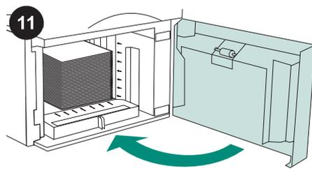
Schließen Sie die Klappe des Zufuhrfachs.
