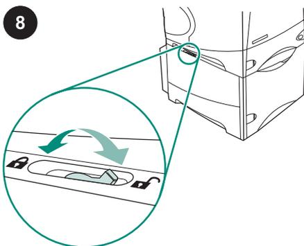
Flyt håndtaget til låsning af bakken (placeret langs den øverste venstre side af bakken) til låst position på hver af de installerede bakker.
