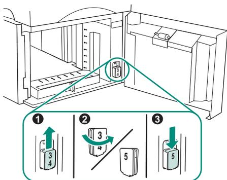
**Gælder kun HP LaserJet 4250/4350:** Hvis arkføderen til 1.500 ark er bakke 5, skal du åbne dækslet til arkføderen, fjerne indikatorblokken med bakkenummeret (billede 1), dreje den rundt (billede 2) og montere den igen, så nummeret 5 vises i åbningen i dækslet (billede 3). Hvis arkføderen ikke er bakke nummer 5, skal du fortsætte til næste trin.
