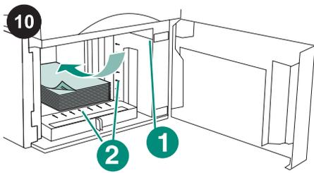
**VOORZICHTIG** Waaier het papier niet uit. Het uitwaaiëren kan leiden tot invoerfouten. Laad het papier in de papierinvoerlade. De hoogte van de stapel mag niet boven de markeringen op de papiergeleiders uitkomen (bijchrift 1). En de voorzijde van de stapel moeten met de pijlen zijn uitgelijnd (bijchrift 2).
