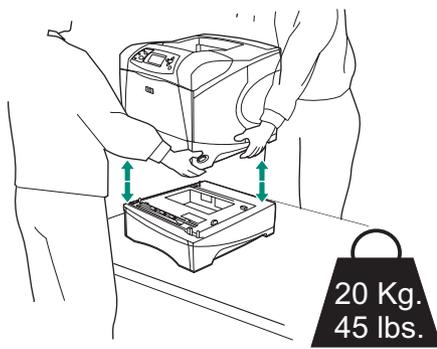
Para evitar posibles lesiones personales o daños al equipo, antes de levantar la impresora sepárela de cualquier alimentador opcional que tenga instalado (dos personas deben levantar la impresora).
