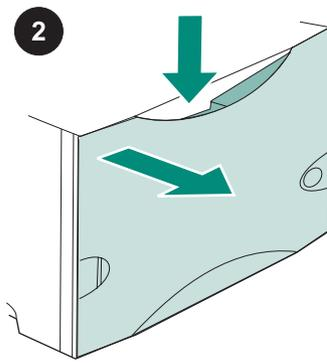
Empuje hacia abajo la palanca de apertura y abra la puerta del alimentador de 1500 hojas.
