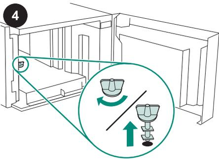
**PRECAUCIÓN** El cierre de la bandeja del alimentador de 1500 hojas *debe* retirarse antes de utilizar el alimentador. Gire el cierre de la bandeja del alimentador hacia la derecha y, a continuación, tire del cierre hacia arriba y hacia fuera del alimentador.
