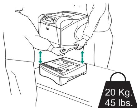
Aby zapobiec urazom ciała lub uszkodzeniu drukarki, przed jej podniesieniem należy zdjąć wszystkie bieżąco zainstalowane opcjonalne podajniki (drukarkę powinny podnosić dwie osoby).
