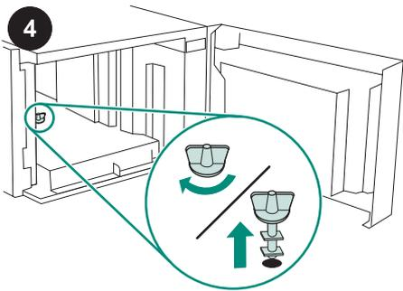
**CUIDADO** Antes de operar o alimentador de envelopes para 1.500 folhas, a trava da sua bandeja *deve* ser removida. Vire a trava da bandeja do alimentador em sentido horário e, em seguida, levante e retire a trava do alimentador.
