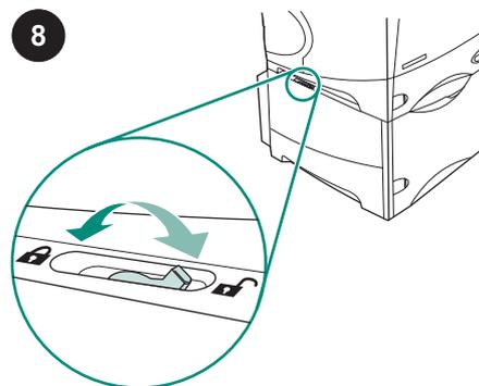
Mettere la leva del blocco del vassoio (sul lato superiore sinistro del vassoio) in posizione di blocco per ciascun vassoio installato.
