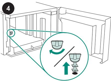
**ATTENZIONE** Prima di utilizzare l'alimentatore è *necessario* togliere il blocco del vassoio dell'alimentatore. Ruotare il blocco del vassoio in senso orario e tirarlo verso l'alto per estrarlo dall'alimentatore.
