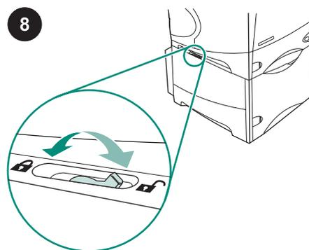
Dla każdego zainstalowanego podajnika należy przestawić dźwignię blokady tacy podajnika (znajdującą się w lewej górnej części tacy) w pozycję zablokowaną.
