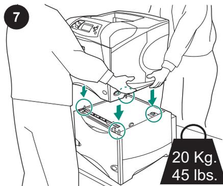
Posizionare l'alimentatore da 1.500 fogli nel punto in cui verrà collocata la stampante. Utilizzando le maniglie laterali, sollevare la stampante sull'alimentatore da 1.500 fogli. Allineare i fori sulla base della stampante ai piedini di montaggio sull'alimentatore da 1.500 fogli.
