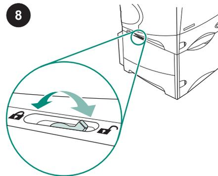
Para cada bandeja instalada, mova a alavanca da trava (localizada junto à lateral superior esquerda da bandeja) até a posição travada.
