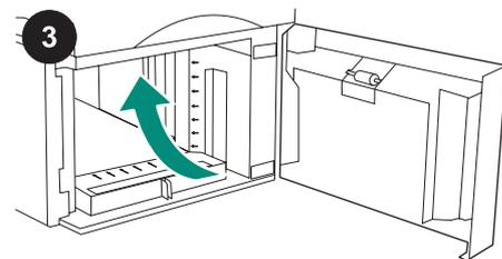
3 Fjern al orange tape og indpakningsmateriale. Bemærk! Du skal kontrollere, at der ikke er indpakningsmateriale og orange tape inden i arkføderen til 1.500 ark.
