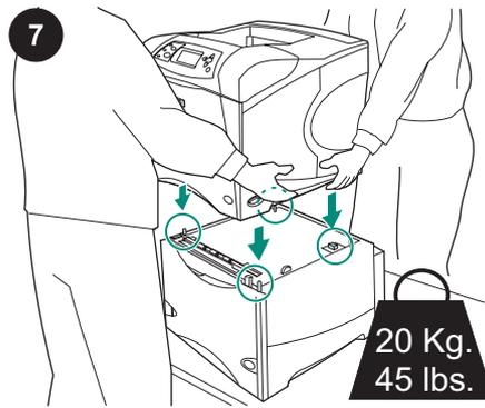
Posicione o alimentador para 1.500 folhas no local em que a impressora será colocada. Usando as alças dos lados da impressora, levante-a por sobre o alimentador para 1.500 folhas. Alinhe os orifícios da base da impressora com os pinos de suporte do alimentador para 1.500 folhas.
