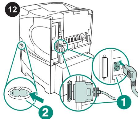
Podłącz kable z tyłu drukarki (rysunek 1). Wyłącz drukarkę (rysunek 2).
