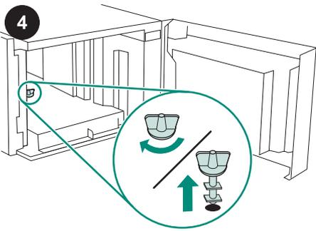
**VARO** 1 500 arkin syöttölaitteen alustan lukko on poistettava ennen syöttölaitteen käyttämistä. Käännä syöttölaitteen alustan lukkoa myötäpäivään. Nosta lukkoa ja irrota se syöttölaiteesta.
