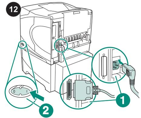
Sluit alle kabels aan op de achterzijde van de printer (bijchrift 1). Zet de printer aan (bijchrift 2).
