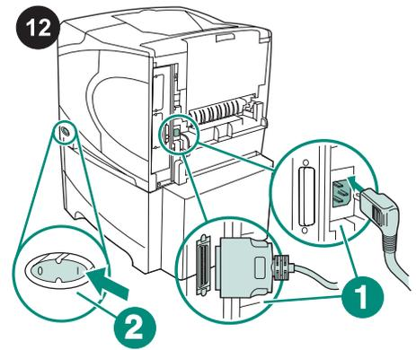
Sätt in kablarna på skrivarens baksida (1). Slå på strömmen till skrivaren (2). **OBS!** Det kan finnas fler kablar som är anslutna till skrivaren än det antal som visas på bilden. Se till att du ansluter *alla* kablar som var anslutna till skrivaren tidigare.
