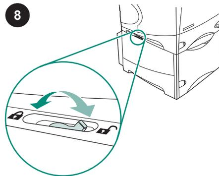
Mueva la palanca del cierre de la bandeja (situado en el lado superior izquierdo de la bandeja) a la posición de bloqueo para cada una de las bandejas instaladas.
