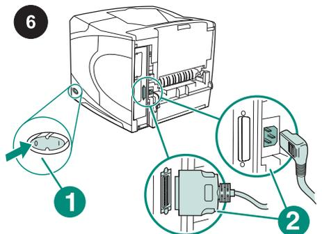
Desligue a impressora (legenda 1). Desconecte todos os cabos da parte traseira da impressora (legenda 2).
