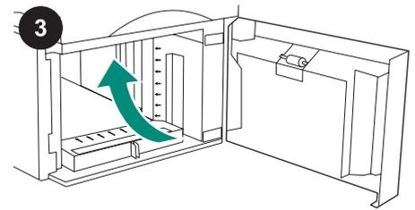
Ta bort all orange tejp och allt förpackningsmaterial. OBS! Kontrollera att det inte finns orange tejp eller förpackningsmaterial inuti mataren för 1 500 ark.
