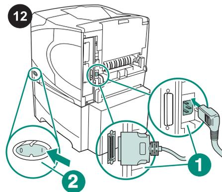
Schließen Sie die Kabel an der Rückseite des Druckers an (1). Schalten Sie den Drucker ein (2).
