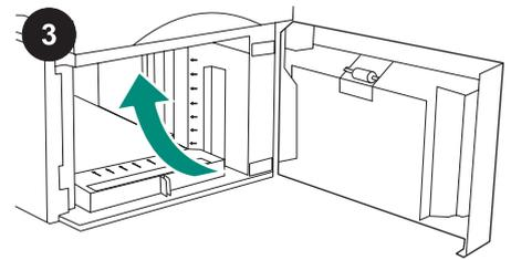
Rimuovere il nastro arancione e il materiale di imballaggio. Nota: Accertarsi di aver rimosso il materiale di imballaggio e il nastro arancione anche all'interno dell'alimentatore da 1.500 fogli.
