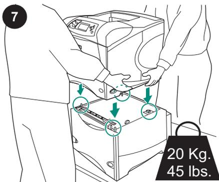
Placer arkføderen til 1.500 ark på det sted, hvor printeren skal placeres. Brug håndtagene på siderne af printeren, og løft printeren op på arkføderen til 1.500 ark. Juster hullerne i bunden af printeren i forhold til monteringsstappene på arkføderen til 1.500 ark.
