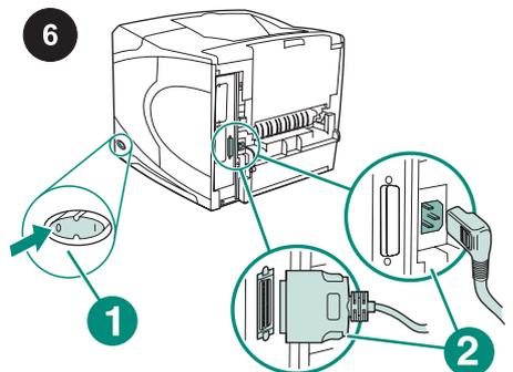
Slå av strömmen till skrivaren (1). Koppla bort alla kablar från skrivarens baksida (2). **OBS!** Det kan finnas fler kablar som är anslutna till skrivaren än det antal som visas på bilden. Se till att du kopplar bort *alla* kablar från skrivarens baksida.
