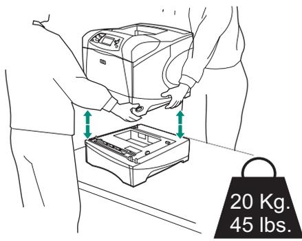
Para evitar possíveis danos, antes de levantar a impressora (o que deve ser feito por duas pessoas), retire qualquer alimentador opcional instalado.
