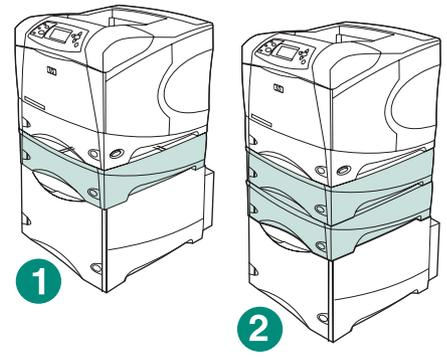
Pour éviter de vous blesser ou d'endommager l'imprimante, retirez tout chargeur optionnel installé sur l'imprimante avant de soulever cette dernière (soulever l'imprimante à deux).
