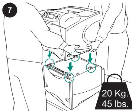
Coloque el alimentador de 1500 hojas en el lugar previsto para la impresora. Levante la impresora utilizando las asas de los laterales para colocarla en el alimentador de 1500 hojas. Alinee los agujeros de la base de la impresora con las patillas de montaje del alimentador de 1500 hojas.
