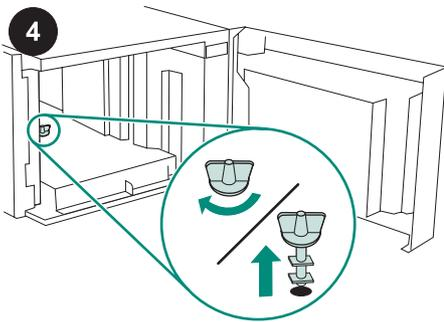
**VORSICHT** Vor Gebrauch des 1500-Blatt-Zufuhrfachs *muss* die Sicherungsvorrichtung entfernt werden. Drehen Sie die Sicherungsvorrichtung des Zufuhrfachs im Uhrzeigersinn, und ziehen Sie die Sicherungsvorrichtung dann nach oben aus dem Zufuhrfach heraus.
