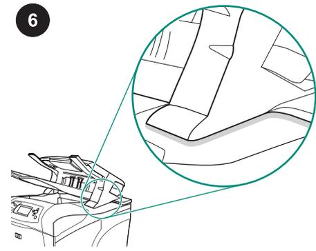
Varmista, että lajittelulaite tai nitova lajittelulaite on tukevasti paikoillaan.
