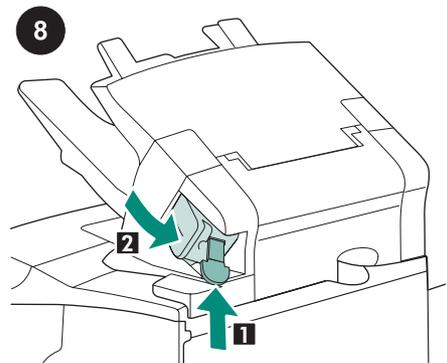
8 Vergewissern Sie sich im Falle eines Hefters/Staplers, dass das Heftklammermagazin (1) eingesetzt wurde und dass die Heftereinheit in der geschlossenen Position eingerastet ist (2).
