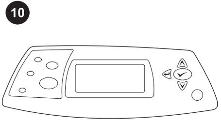
Aguarde até que o aviso **PRONTA** apareça no visor do painel de controle da impressora.
