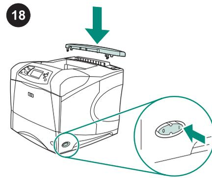
18 Reinstale a tampa de acessório. Ligue a impressora.
