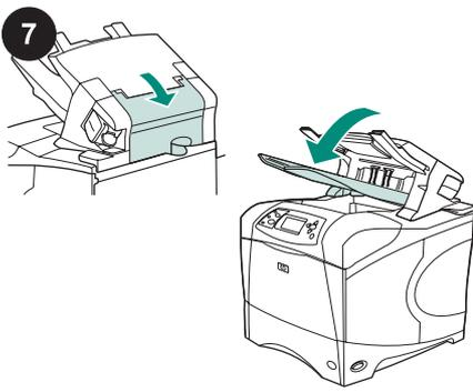
Assurez-vous que la porte d'accès aux bourrages est fermée, et que le bac de sortie du bac d'empilement ou du ou le bac d'empilement/agrafeuse est réglé sur la position la plus basse.
