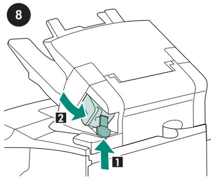
Om enheten är en enhet för häftning/stapling kontrollerar du att häftkassetten (1) är installerad, och att häftningsenheten är i det stängda läget (2).
