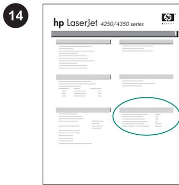
Let erop dat de configuratiepagina de nietmachine/stapelaar als geïnstalleerde accessoire herkent. Wanneer de stapelaar of nietmachine/stapelaar niet wordt weergegeven op de configuratiepagina, raadpleegt u de gebruikershandleiding op de cd-rom die bij de printer is geleverd.
