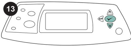
13 Pour vérifier que l'installation est terminée, imprimez une page de configuration via le panneau de commande. Appuyez sur pour accéder aux menus de l'imprimante. Appuyez sur pour sélectionner **INFORMATIONS**, puis sur . Appuyez sur pour sélectionner **IMPRIMER PAGE CONFIGURATION**, puis sur .
