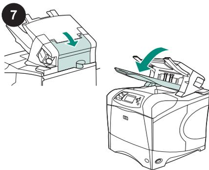
7 Sprawdź, czy drzwiczki umożliwiające usunięcie zacięcia papieru są zamknięte, a pojemnik wyjściowy układacza lub zszywacza/układacza znajduje się w najniższym położeniu.
