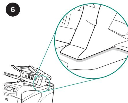
Controllare che l'impilatrice o la cucitrice/impilatrice siano saldamente fissate.
