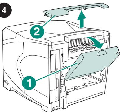
Otwórz tylny pojemnik wyjściowy (rysunek 1). Zdejmij osłonę wyposażenia dodatkowego znajdującą się w górnej tylnej części drukarki (rysunek 2). Zamknij tylny pojemnik wyjściowy.
