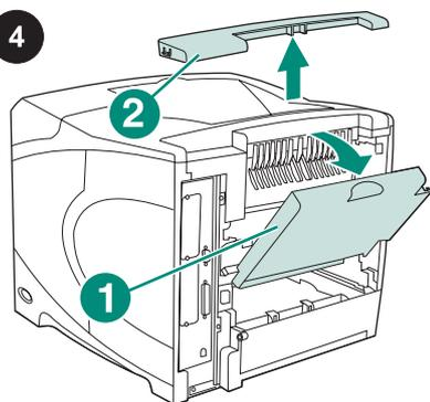
Aprire lo scomparto di output posteriore (richiamo 1). Rimuovere il coperchio accessorio che si trova in alto nella parte posteriore della stampante (richiamo 2). Chiudere lo scomparto di uscita posteriore.
