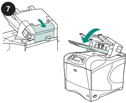
7 Stellen Sie sicher, dass die Zugangsklappe für Staus geschlossen ist und sich das Ausgabefach des Staplers oder Hefters/ Staplers in der tiefsten Position befindet.
