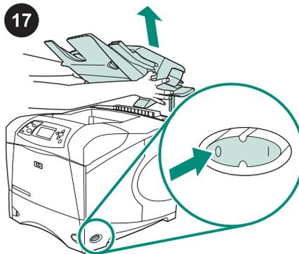
17 **Pour retirer le bac d'empilement ou le bac d'empilement/agrafeuse.** Mettez l'imprimante hors tension. Soulevez le bac d'empilement ou le bac d'empilement/agrafeuse afin de retirer les pieds métalliques des logements de l'imprimante.
