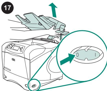
17 **Para remover o empilhador ou grampeador/empilhador.** Desligue a impressora. Levante o empilhador ou grampeador/empilhador até que as lingüetas de metal saiam dos slots da impressora.
