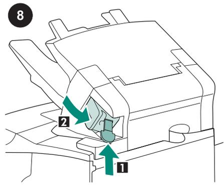
8 Si el dispositivo es un grapador/apilador, asegúrese de que esté instalado el cartucho del grapador (leyenda 1) y que la unidad grapadora se encuentre en la posición cerrada (leyenda 2).
