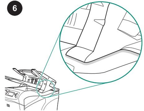
Zorg ervoor dat de stapelaar of nietmachine/stapelaar stevig vastzit.
