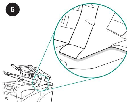
Kontroller, at stackeren eller hæfteenheden/stackeren sidder solidt fast.
