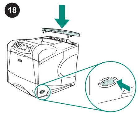
18 Załóż osłonę wyposażenia dodatkowego. Włącz drukarkę.
