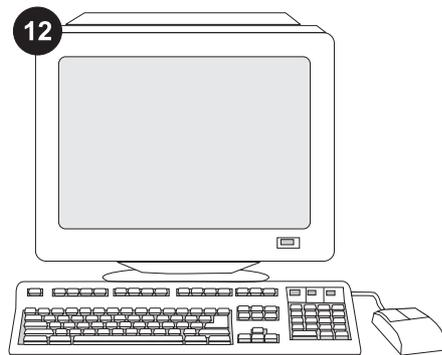
12 Skonfigurowanie sterownika drukarki na komputerze drukarki tak, aby rozpoznawał zszywacz/układacz lub układacz, jest warunkiem pełnego wykorzystania wszystkich funkcji układacza lub zszywacza/układacza. W przypadku systemu Windows® przejdź do okna Właściwości. Na karcie **Ustawienia urządzenia**, zaznacz pole wyboru odpowiadające układaczowi lub zszywaczowi/układaczowi.
