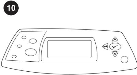
10 Espere hasta que aparezca **LISTO** en la pantalla del panel de control de la impresora.
