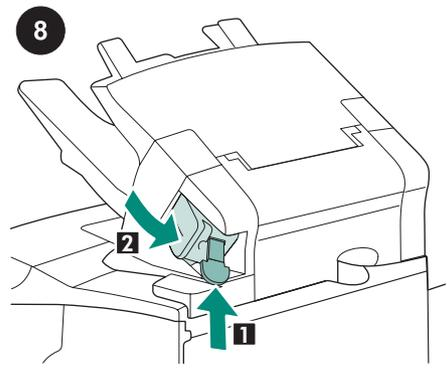
Als u een nietmachine/stapelaar gebruikt, zorgt u ervoor dat de nietjescassette (bijlschrift 1) is geïnstalleerd en dat de nietmachine is vastgeklipd in de gesloten positie (bijlschrift 2).
