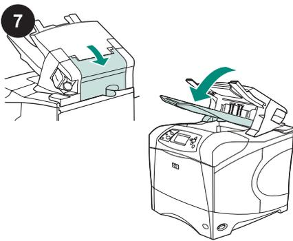
Kontrollera att paperstrasselluckan är stängd och att utmatningsfacket för staplingsenheten eller enheten för häftning/stapling är i den lägsta positionen.
