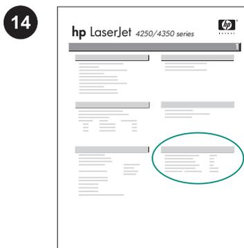
Kontroller at konfigurasjonssiden viser stableenheten eller stifte-/stableenheten som installert ekstrautstyr. Hvis stableenheten eller stifte-/stableenheten ikke er oppført på konfigurasjonssiden, kan du se i brukerhåndboken på CD-ROMen som fulgte med skriveren.
