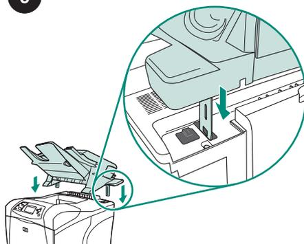
Soulevez le bac d'empilement ou le bac d'empilement/agrafeuse. Insérez ses pieds métalliques dans les logements situés dans la partie supérieure de l'imprimante, à l'arrière.
