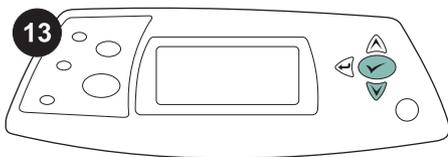
For å kontrollere at installeringen er fullført kan du skrive ut en konfigurasjonsside fra kontrollpanelet. Trykk på ✓ for å åpne skrivermenyene. Trykk på ▼ for å velge **INFORMASJON**, og trykk deretter på ✓. Trykk på ▼ for å velge **SKRIV UT KONFIGURASJON**, og trykk deretter på ✓.
