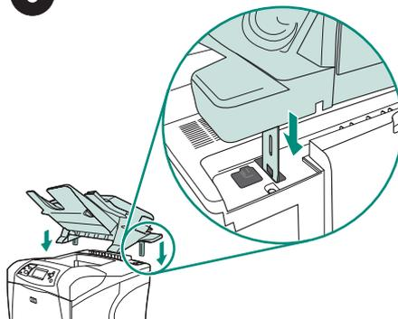
Afferrando saldamente l'impilatrice o la cucitrice/impilatrice, inserire i supporti metallici negli appositi alloggiamenti che si trovano in alto nella parte posteriore della stampante.
