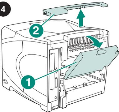
Öppna det bakre utmatningsfacket (1). Ta bort tillbehörluckan högst upp på skrivarens baksida (2). Stäng det bakre utmatningsfacket.
