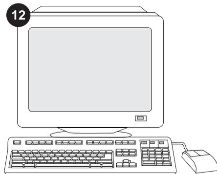
12 Jotta kaikkia lajittelulaitteen tai nitovan lajittelulaitteen toimintoja voi käyttää, tulostimen isäntätietokoneeseen asennettu tulostinohjain on määritettävä tunnistamaan laite. Avaa Windows®-käyttöjärjestelmän tulostimen ominaisuusikkuna. Lisää **Laiteasetukset**-välilehdessä valintamerkki lajittelulaitteen tai nitovan lajittelulaitteen kohdalle.
