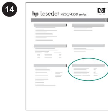
14 Sur la page de configuration, assurez-vous que le bac d'empilement et agrafeuse, ou le bac d'empilement, est considéré comme un accessoire installé. Si le bac d'empilement ou le bac d'empilement/agrafeuse n'est pas répertorié sur la page de configuration, reportez-vous au guide d'utilisation disponible sur le CDROM fourni avec l'imprimante.
