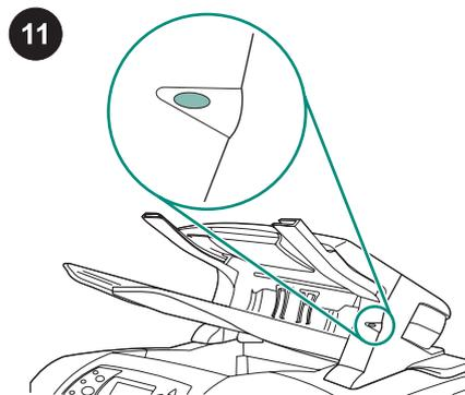
Kontrollera att lampan på framsidan av staplingsenheten eller enheten för häftning/stapling lyser grönt. Om lampan lyser gult, blinkar eller inte lyser finns information i "Förstå tillbehörslampor för staplingsenheten och enheten för häftning/stapling" i användarhandboken på cd-romskivan som medföljer skrivaren.
