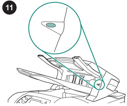
Controleer of het lampje op de voorkant van de stapelaar of nietmachine/stapelaar groen brandt. Als het lampje oranje brandt, knippert of uit is, raadpleegt u "Uitleg accessoirelichtjes voor de stapelaar en nietmachine/stapelaar" in de gebruikershandleiding op de cd-rom die bij de printer is geleverd.
