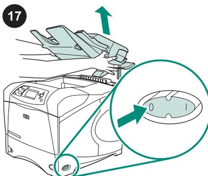
**Slik fjerner du stableenheten eller stifte-/stableenheten.** Slå av skriveren. Løft stableenheten eller stifte-/stableenheten opp til metalltappene er helt ute av sporene på skriveren.
