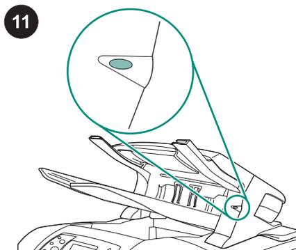
11 Sprawdź, czy kontrolka znajdująca się z przodu układacza lub zszywacza/układacza świeci się na zielono. Jeżeli kontrolka świeci na bursztynowo, miga lub nie świeci się, zobacz rozdział „Znaczenie kontrolki wyposażenia układacza i zszywacza/układacza” w instrukcji obsługi na dołączonym do drukarki dysku CD-ROM.
