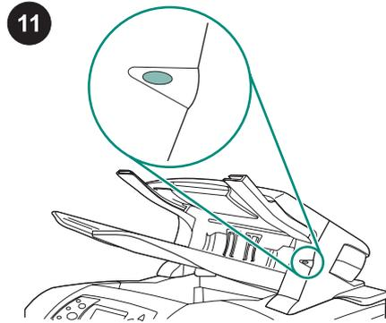
11 Compruebe que la luz en la parte frontal del apilador o grapador/apilador sea de color verde y no parpadee. Si la luz es de color ámbar, parpadea o no se enciende, consulte "Luces de accesorios del apilador y grapador/apilador" en la guía de uso del CD-ROM que acompaña a la impresora.
