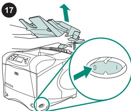
**Sådan fjernes stackeren eller hæfteenheden/stackeren.** Sluk printeren. Løft stackeren eller hæfteenheden/stackeren op, indtil metalbenene er fjernet fra hullerne på printeren.
