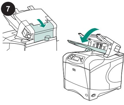
Let erop dat de toegangsklep voor papierstoringen is gesloten en dat de uitvoerbak van de stapelaar of nietmachine/ stapelaar zich in de onderste positie bevindt.
