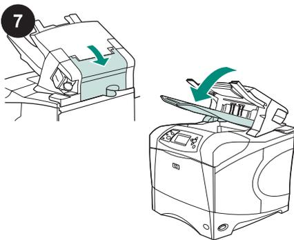
7 Varmista, että tukosten selvittämiseen tarkoitettu luukku on kiinni ja että lajittelulaitteen tai nitovan lajittelulaitteen tulostelokero on alimmassa asennossa.
