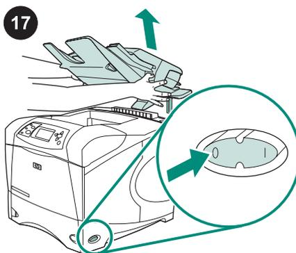
17 Aby usunąć układacz lub zszywacz/układacz. Wyłącz drukarkę. Unieś układacz lub zszywacz/układacz aż do wyjęcia metalowych nóżek z otworów drukarki.
