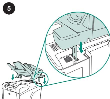
Segurando firmemente o empilhador ou grampeador/empilhador, encaixe as lingüetas de metal nos slots da parte superior traseira da impressora.
