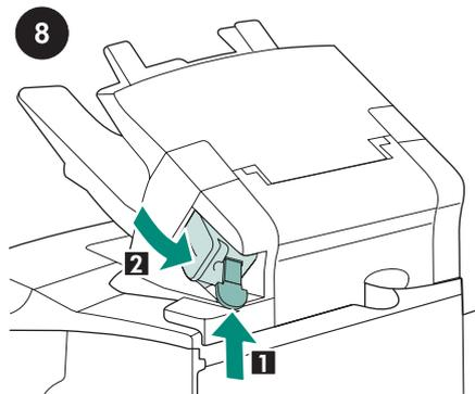
8 W przypadku zszywacza/układacza należy upewnić się, czy zainstalowano pojemnik ze zszywkami (rysunek 1) oraz czy zszywacz został zatrzaśnięty w pozycji zamkniętej (rysunek 2).
