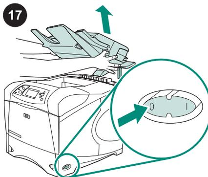
**So entfernen Sie den Stapler oder Hefter/Stapler:** Schalten Sie den Drucker aus. Heben Sie den Stapler oder Hefter/Stapler an, bis die Metallstifte aus den Schlitzen am Drucker gleiten.
