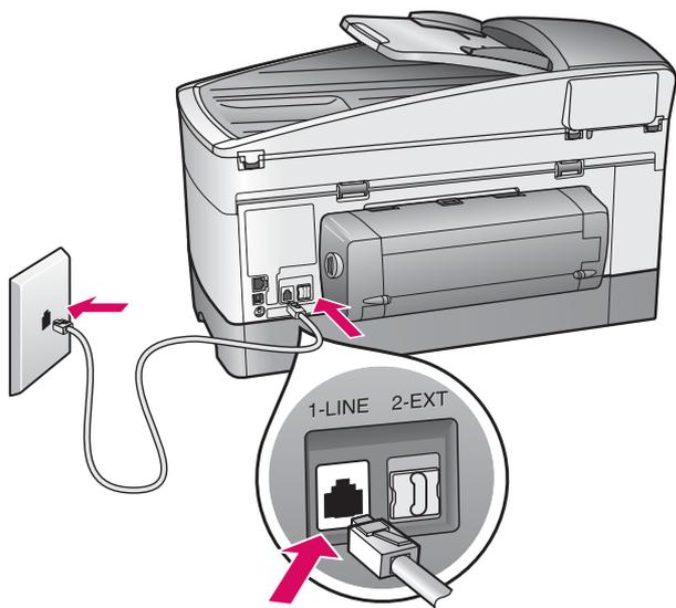
Подсоедините один конец прилагаемого телефонного кабеля к порту для телефона (**1-LINE**) (ЛИНЕЙНЫЙ 1), а другой - к стенной розетке.
