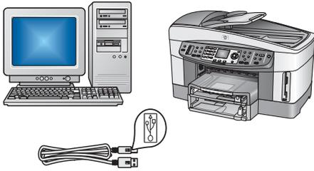
Используйте этот тип соединения, если необходимо подключить аппарат непосредственно к одному компьютеру. **(не выполняйте соединения, пока соответствующее указание не появится в программном обеспечении).**
