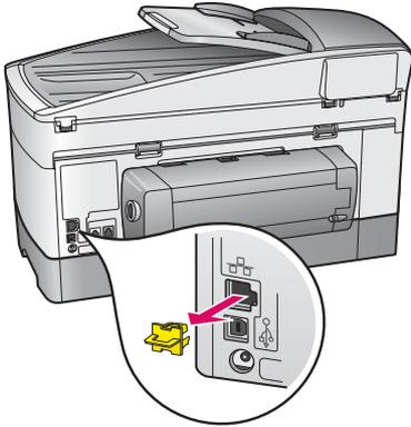
а Удалите желтую заглушку на задней панели аппарата.
