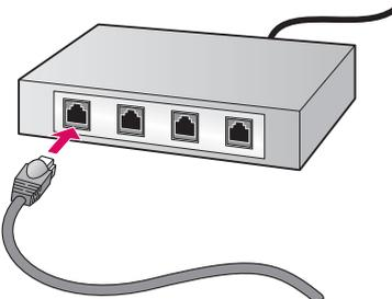
**Важно!** Не подсоединяйте кабель Ethernet к кабельному модему. Для подсоединения необходима работающая сеть. Не подсоединяйте кабель Ethernet, если уже выполнено подсоединение с помощью кабеля USB.
