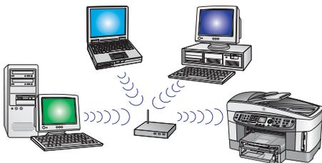
Используйте этот тип соединения, если между аппаратом и сетью необходимо установить беспроводное (802.11 b или g) соединение.
