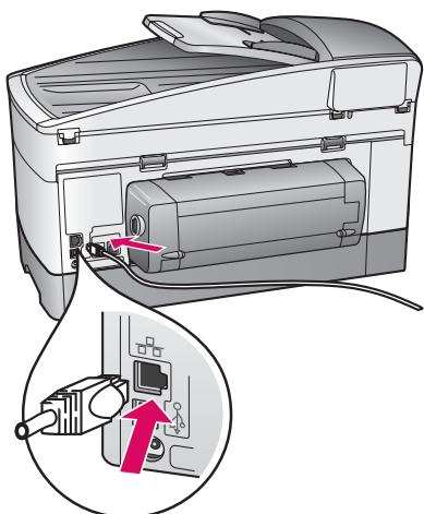
b 將乙太纜線的一端連接到裝置後面的乙太連接埠。
