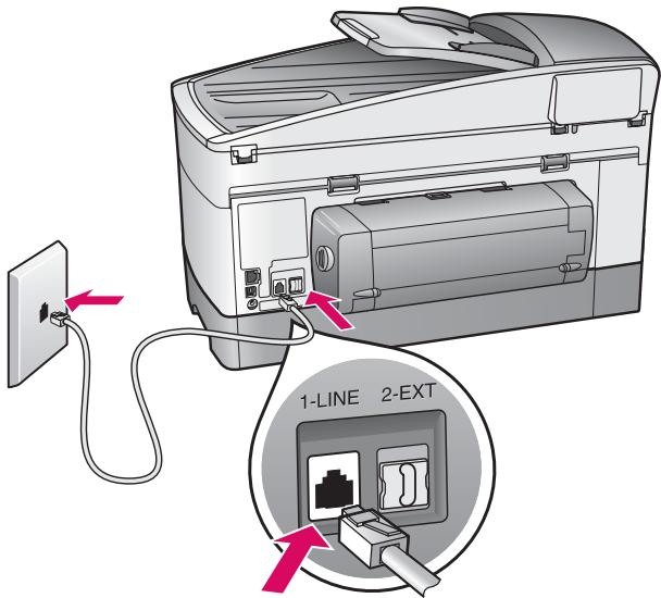
將提供的電話線一端連接到左側 **(1-LINE)** 上的電話連接埠，另一端連接到牆壁上的插孔。
