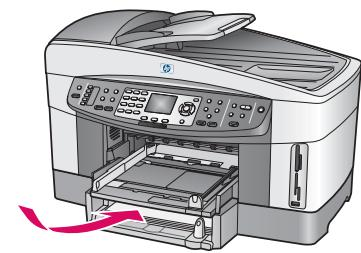
d 將紙張裝入底端的紙匣，並調整導板。將底端的紙匣放回。
