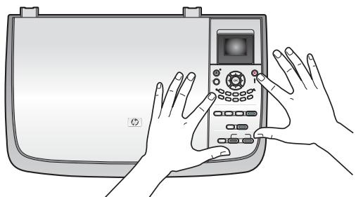
**a** Plaats de overlay van het bedieningspaneel op het apparaat.
