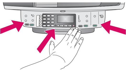
**a** Alinhe as guias do overlay do painel de controle com o dispositivo e, em seguida, abaixe-o.
