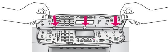
**a** Alinee las pestañas de la plantilla del panel de control con el dispositivo y bájelo.
