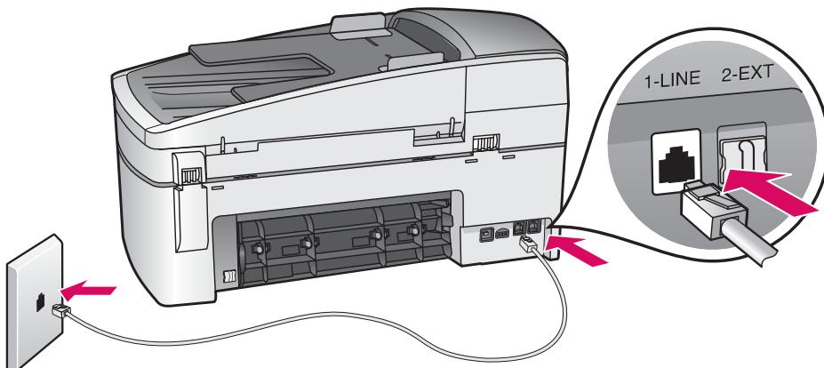
Conecte un extremo del cable telefónico suministrado al puerto telefónico situado a la izquierda **1-LINE** (línea 1) y el otro extremo a un conector de pared.
