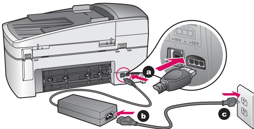
**Importante:** No conecte el cable USB hasta el paso 16 o puede que el software no se instale correctamente. Siga los pasos en orden.
