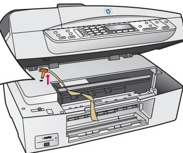
Soulevez la porte d'accès et retirez le **dispositif de sécurité d'expédition orange**.
