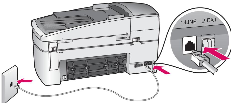
Connectez une extrémité du cordon téléphonique fourni au port de téléphone sur la gauche (**1-LINE**) (ligne 1) et l'autre extrémité à une prise murale.
