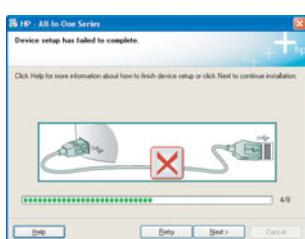
**Probleem:** (Alleen Windows) Het scherm **Installatie van het apparaat kon niet worden voltooid** verschijnt.
