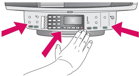
a Lijn de tabs van de overlay voor het bedieningspaneel uit met het apparaat en leg de overlay neer.
