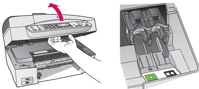
アクセスドアを完全に引き上げます。プリントカートリッジが右側へ移動するのを確認します。
