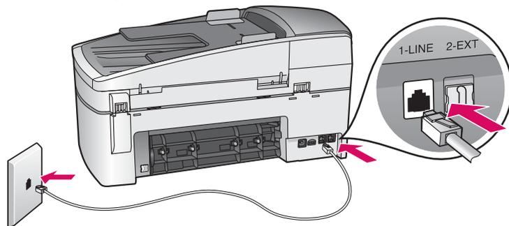
付属の電話コードの一方のコネクタを左側の電話ポート **1-LINE** (回線 1) に接続し、もう一方のコネクタを壁側ジャックに接続します。
