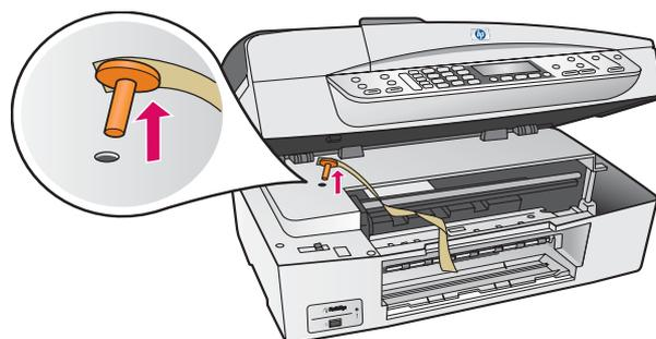
アクセス ドアを持ち上げて、オレンジ色の出荷用ロックを取り外します。
