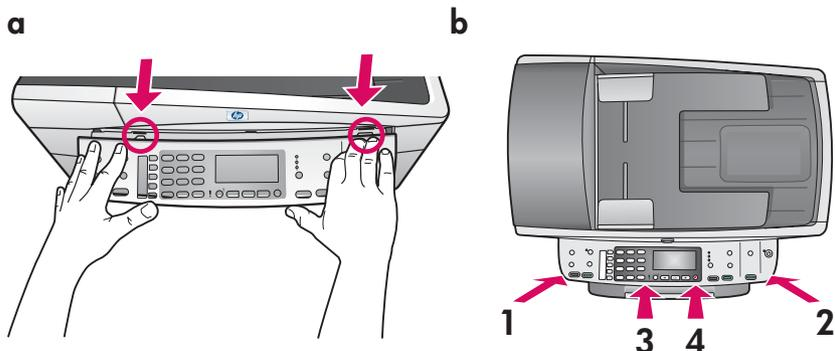
a コントロールパネル オーバレイの各タブの位置をプリンタに合わせて調節し、下げます。
