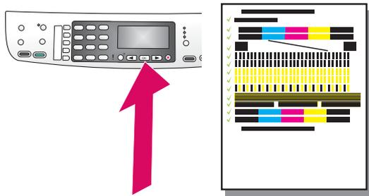
a コントロールパネルの各メッセージに対して **OK** を押し、プリントカートリッジの調整を開始します。
