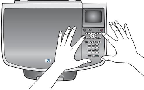
**a** Plaats de overlay van het bedieningspaneel op het apparaat.
