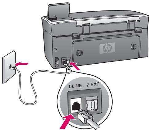
Connectez une extrémité du cordon téléphonique fourni au port de téléphone sur la gauche (**1-LINE**) (ligne 1) et l'autre extrémité à une prise murale.
