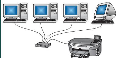
Utilizzare questo tipo di collegamento se si desidera stabilire, tramite cavo Ethernet, un collegamento, della periferica alla rete.
