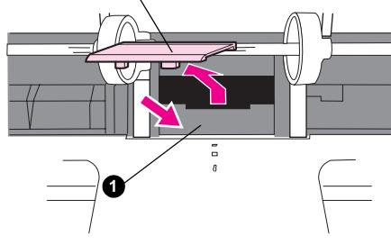
Introduisez un tournevis à tête plate dans la fente située sous le tampon de séparation. A l'aide du tournevis, soulevez le tampon du socle où se trouve le ressort jusqu'à ce que les embouts soient séparés de l'imprimante.
