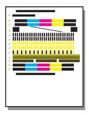
a 在控制面板的每個提示中按「OK」開始校正列印墨匣。
