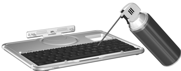
使用壓縮空氣罐清理平板 PC 鍵盤
