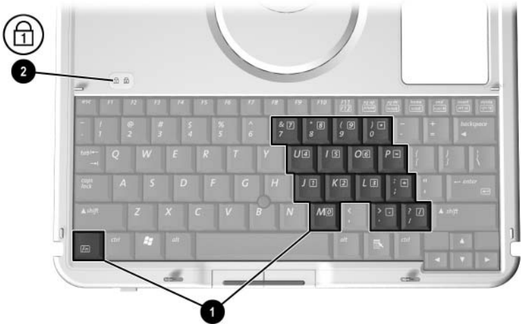
Identificación de las teclas Fn y Bloq Num y de la luz Bloq Num
