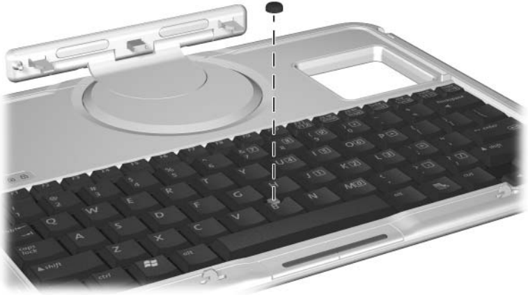
Reemplazo de la cubierta del control señalador
