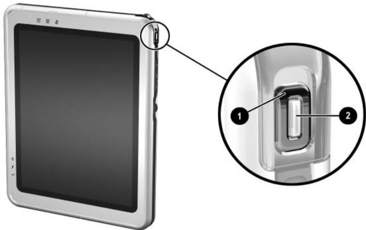
*Identificación del interruptor de encendido y de la luz de alimentación/Suspensión*
