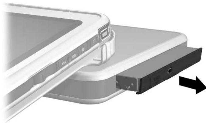
*Remoção de um dispositivo MultiBay*
