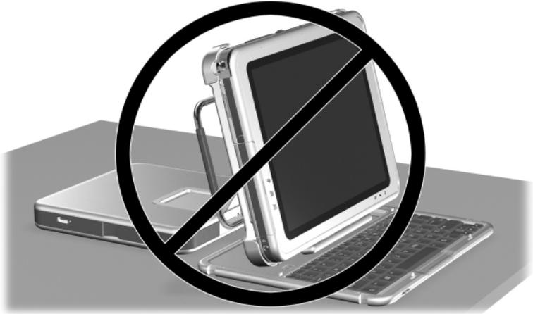
*Tablet PC incorretamente acoplado com o teclado conectado*
