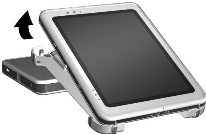
*Remoção do Tablet PC do suporte de acoplamento*
