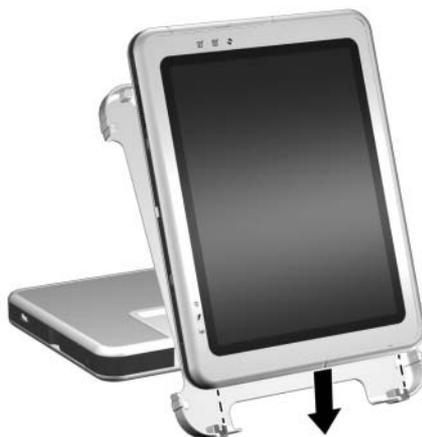
*Encaixe da borda inferior do Tablet PC no suporte de acoplamento na posição retrato*
