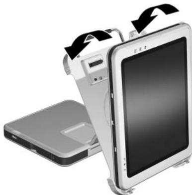
*Alinhamento e posicionamento dos conectores de acoplamento na posição retrato*
