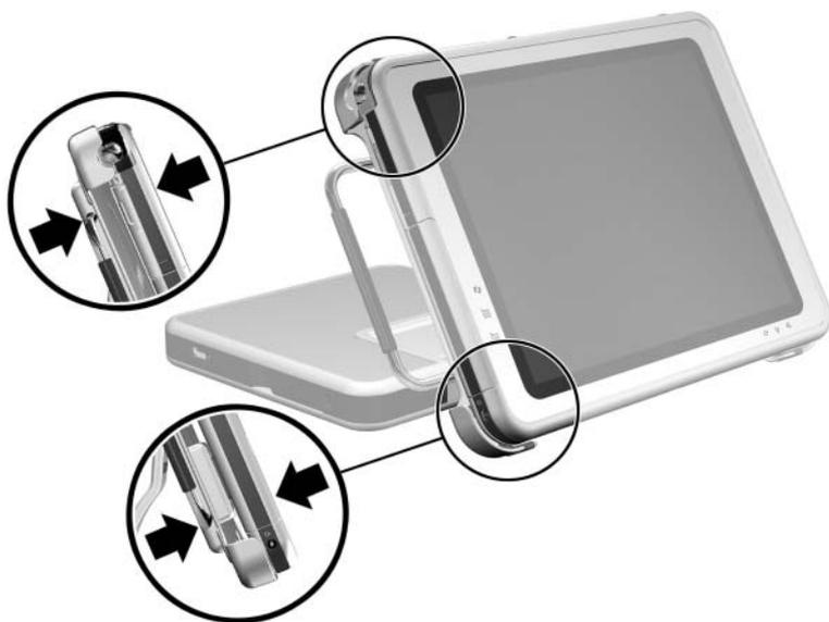
*Identificação dos pontos de pressão do Tablet PC no suporte de acoplamento na posição paisagem*
