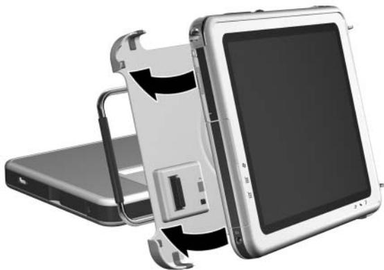
*Alinhamento e posicionamento dos conectores de acoplamento na posição paisagem*
