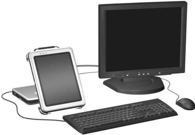
*Tablet PC acoplado no modo de visualização com monitor externo, teclado e mouse*
