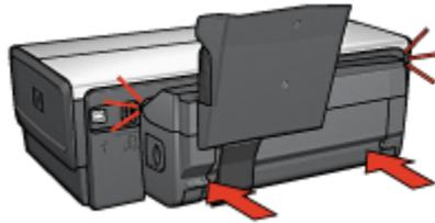
Nota: no presione los botones a ambos lados del accesorio cuando lo instale en la impresora. Utilice los botones sólo cuando vaya a desinstalarlo.
