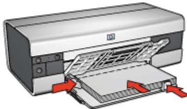
7. Baje la bandeja de Salida y, a continuación, extraiga la extensión de la bandeja de Salida.
