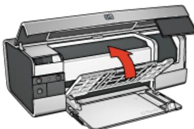
4. Compruebe que se ha recogido la extensión de la bandeja de Entrada y, después, tire del ajustador del largo del papel hasta el borde de la bandeja de Entrada.
