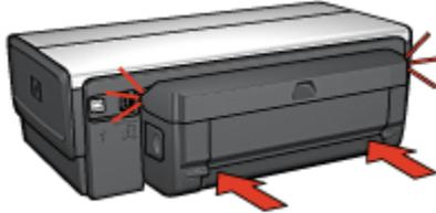
Nota: no presione los botones a ambos lados del dispositivo cuando lo instale en la impresora. Utilice los botones sólo cuando vaya a desinstalarlo.
