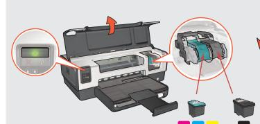
Pull pink tab to remove clear tape. 抓住粉紅色拉片撕下透明膠帶。 분홍색 탭을 당겨 투명 테이프를 제거합니다. 拉起粉色小片,撕掉透明胶带。
