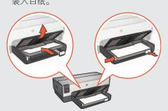
Lower Out tray. Pull out extension. 放低出紙匣。拉出延伸板。 출력 용지함을 내리고 확장대를 잡아당깁니다. 放下出纸盘。拉出延长板。
