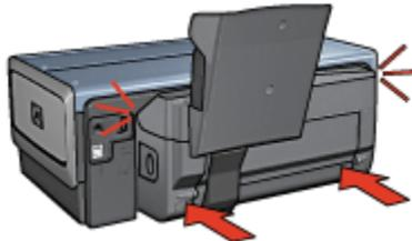
Hinweis: Drücken Sie beim Anbringen des Zubehörs am Drucker nicht die Tasten, die sich an beiden Seiten befinden. Verwenden Sie diese nur, wenn Sie das Zubehör vom Drucker entfernen.
