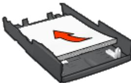
4. Setzen Sie das untere Papierfach in die Basis ein, und lassen Sie es einrasten.
