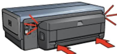
Hinweis: Achten Sie bei der Montage darauf, dass Sie nicht die Tasten an den Seiten des Duplexers drücken. Drücken Sie diese Tasten nur, wenn Sie das Modul vom Drucker abnehmen.
