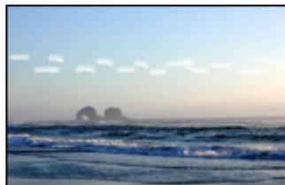
Si des taches d'encre apparaissent dans une partie claire, à environ 64 mm d'une des longueurs de la photo, procédez de la manière suivante.
