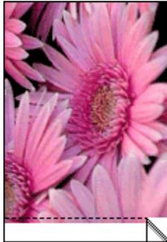
Si la bordure apparaît au-dessus de la languette de déchirage, [alignez les cartouches d'encre.](#)
