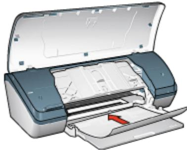
5. Poussez doucement les transparents dans l'imprimante jusqu'à ce qu'ils soient bloqués, de façon à ce que les bandes adhésives ne se chevauchent pas.
