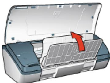
6. Fassen Sie unter das Zufuhrfach, und drücken Sie es nach oben, bis es hörbar einrastet.
