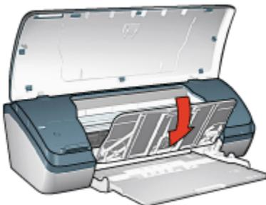
4. Ziehen Sie die Verlängerung des Ausgabefachs heraus, und klappen Sie den Anschlagbügel nach oben.
