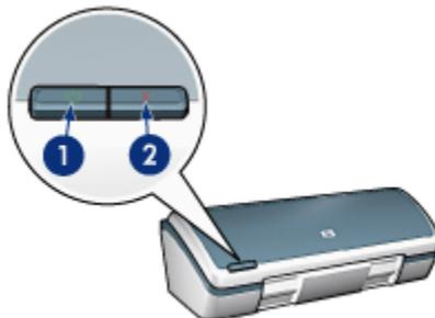
1. Netzschalter und Netz-LED
