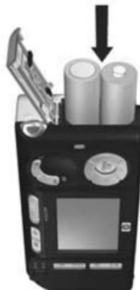
Taču, ja jums nav jāievieto papildu atmiņas karte, aizveriet bateriju/atmiņas kartes vāciņu, noliecot to uz leju un pabīdot virzienā uz kameras augšpusi, līdz vāciņš nofiksējas. Pēc tam skatiet **Ieslēgšana** 12. lpp.
