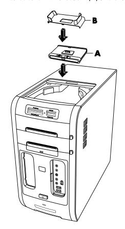
3 将带有数码相机的相机支架 (B) 放在相机转接器上。该支架插入相机转接器。
