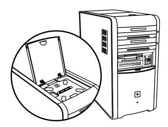
此功能让您可以在电脑机箱上安装专用转接器挡板(可选),以使用 HP 相机和 HP 相机转接器。(相机和转接器均单独销售。)相机包含相机支架,转接器包 含电缆。
