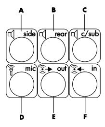
上图显示了位于电脑背面的 6 个音频接口: 其中四个用于八声道音频,一个用于麦克风 (**D**, mic),一个用于音频线路输入 (**F**, in)。
