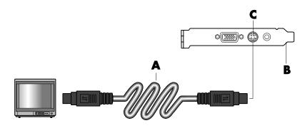
• 如果电视有复合视频接口,电脑也有复合视频接口,可用复合视频电缆一端连接电视上的 Video In 接口,一端连接电脑背面的复合视频接口。
