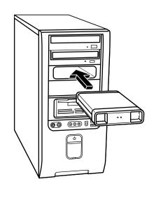
这种特殊的硬盘驱动器托架含有内部 USB 接口和电源线,它们用于连接插入的硬盘驱动器。
