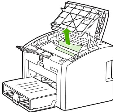
3. После устранения замятия носителя вставьте на место картридж и закройте дверцу доступа к картриджу.
