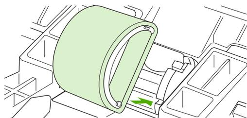
7. Проверните верхнюю часть ролика от себя, пока обе стороны не будут зафиксированы.
