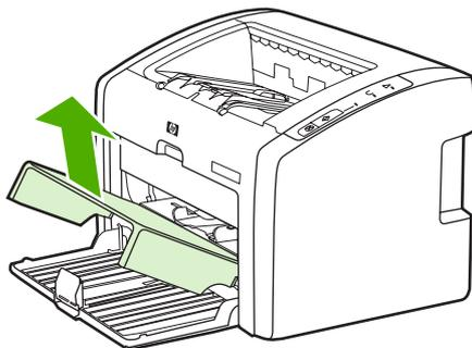
2. Перед загрузкой конвертов раздвиньте направляющие носителя чуть шире конвертов.
