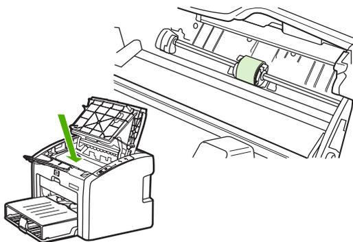
4. Освободите небольшие белые фиксаторы с обеих сторон подающего ролика и проверните ролик вперед.
