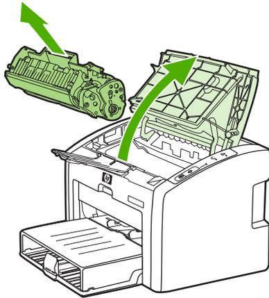
3. С помощью сухой ткани без ворса протрите путь прохождения носителя для печати и отсек картриджа.
