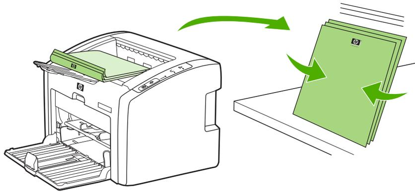
5. Снова загрузите стопку в подающий лоток. Первая отпечатанная сторона должна быть расположена вниз, нижнем краем к принтеру. Закройте крышку носителя подающего лотка.
