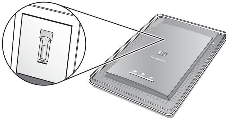
带内置透明材料适配器 (TMA) 的扫描仪
