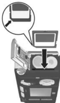
Para extraer la tarjeta de memoria de la cámara, primero apague la cámara. Abra la puerta de la pila/tarjeta de memoria y presione el borde superior de la tarjeta; ésta saltará fuera de la ranura.
