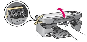
افتح باب الوصول. قم بإزالة الشريط من الداخل. قم بفصل التيار الكهربائي ثم انتظر لمدة دقيقة واحدة. قم بتوصيل التيار الكهربائي مرة أخرى.
