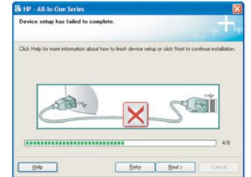
تأكد من إحكام تثبيت غطاء تركيب لوحة التحكم. افصل التيار الكهربائي عن الجهاز ثم أعد توصيله. تحقق من كل التوصيلات. تأكد من توصيل كبل USB بالكمبيوتر. لا تقم بتوصيل كبل USB بلوحة المفاتيح أو بموزع شبكة غير مزود بالطاقة. راجع الخطوات ٤ و ١٦.
