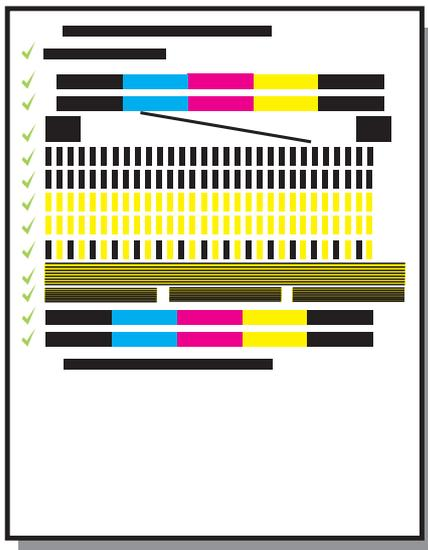
**a** Premere **OK** a ogni richiesta di iniziare il processo di allineamento delle cartucce di stampa visualizzata sul pannello di controllo.
